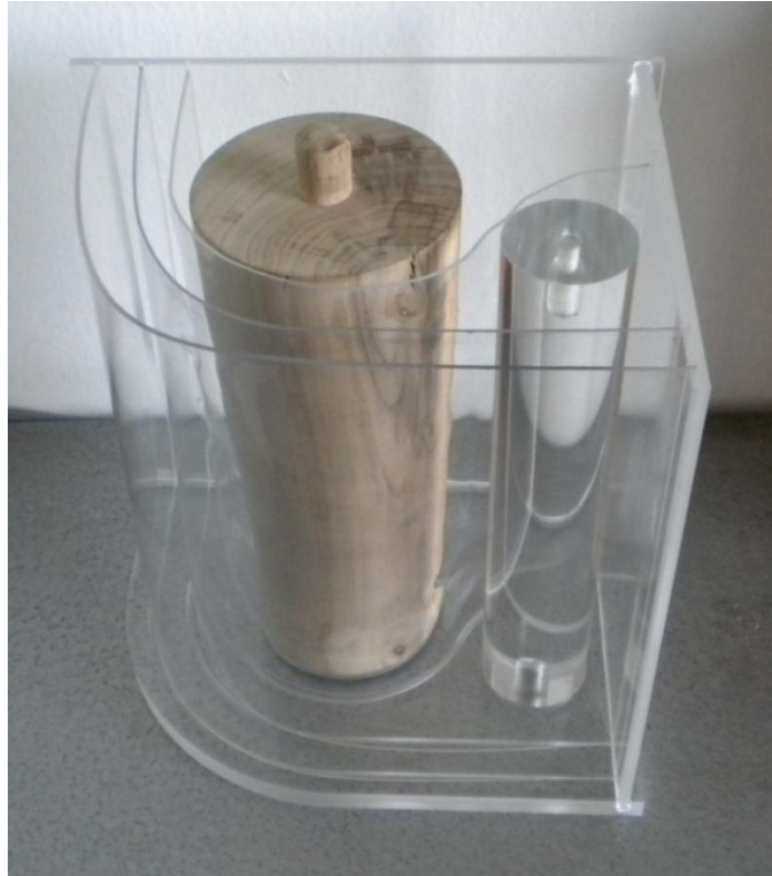
Figura 4.6.2 Fotografia della struttura di contenimento, si individua lo spaziatore per capsula renale e le paratie.
