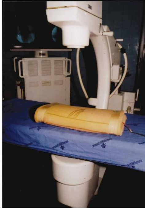
Figura 2.2.7 Fantoccio di De Sà Earp: il modello, chiuso alle estremità con dello scotch, è posizionato sul tavolo radioscopico; si nota il disegno della undicesima e dodicesima costola e il catetere ureterale che fuoriesce della gommapiuma.
