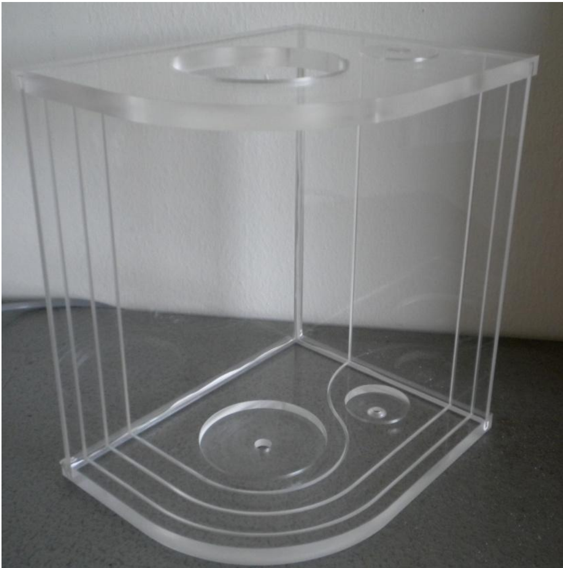
Figura 4.6.1 Fotografia dei componenti Base, Parete 1, Parete 2 e Coperchio assemblati.
