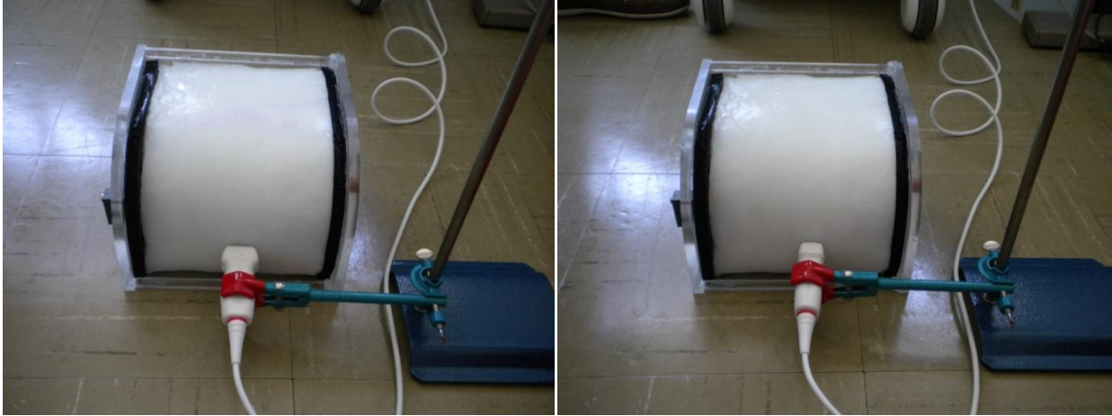
Figura 5.1.2 Posizionamento della sonda ecografica parallelamente (a sinistra) e perpendicolarmente (a destra) all'asse del fantoccio.
