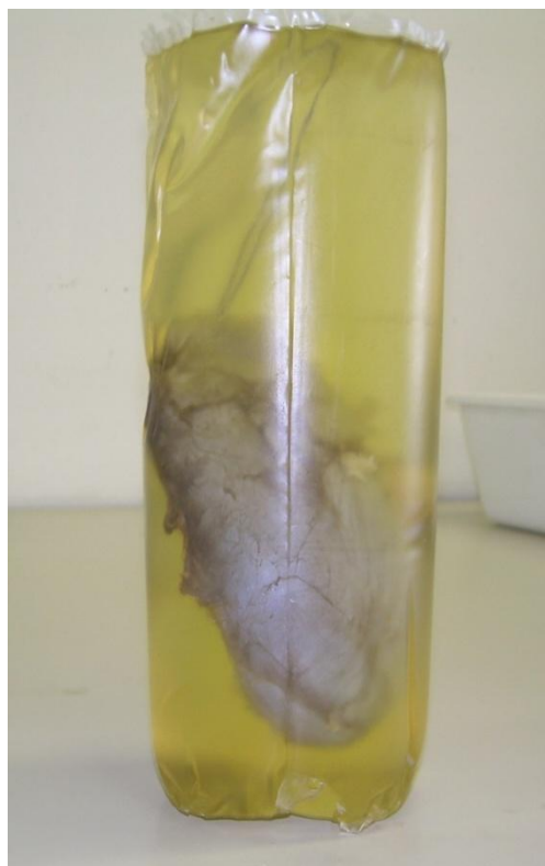
Figura 4.7.10 Capsula renale in gelatina alimentare contenente il rene porcino.
