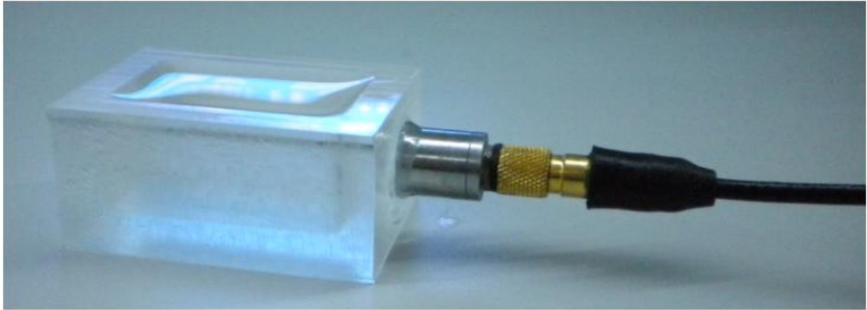
Figura 3.2.2 Sonda M110-SM US (Olympus-NDT, MA, US) posta a contatto del portaprovino tramite uno strato di gel per ultrasuoni.
