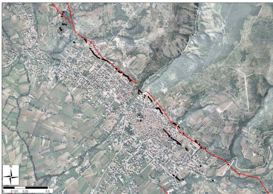
Figura 3.8. In rosso è tracciata la faglia di Paganica, in nero i punti in cui si sono osservate evidenze di faglia in superficie. I due elementi, considerando una zona di rispetto di 100 m, sono coincidenti
