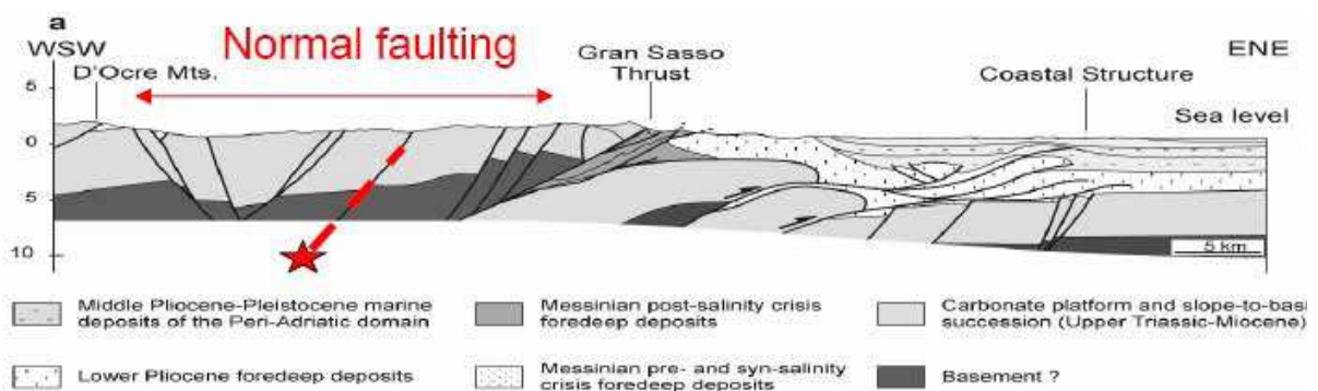
Figura 3.7. Sezione verticale della zona dell'aquilano in cui viene messo in evidenza il sistema di faglie normali. La faglia segnata in rosso è la Paganica
