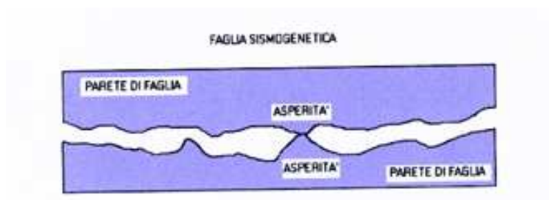
Figura 2.9. Rappresentazione schematica del concetto di asperità su di un piano di faglia (Ruiz, 2007)
