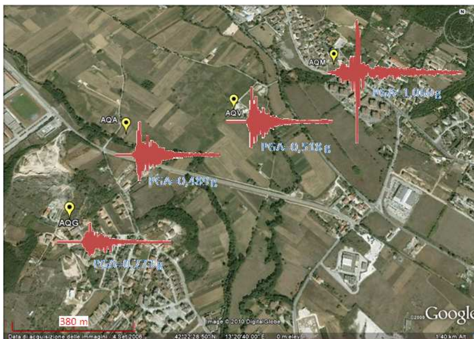
Figura 6.14. Ubicazione delle stazioni AQA, AQG, AQM e AQV, relativi accelerogrammi e valori dei PGA in direzione vt (PGAaqm=1,060g; PGAaqv=0,518g; PGAaqa=0,489g; PGAaqg=0,273g)
