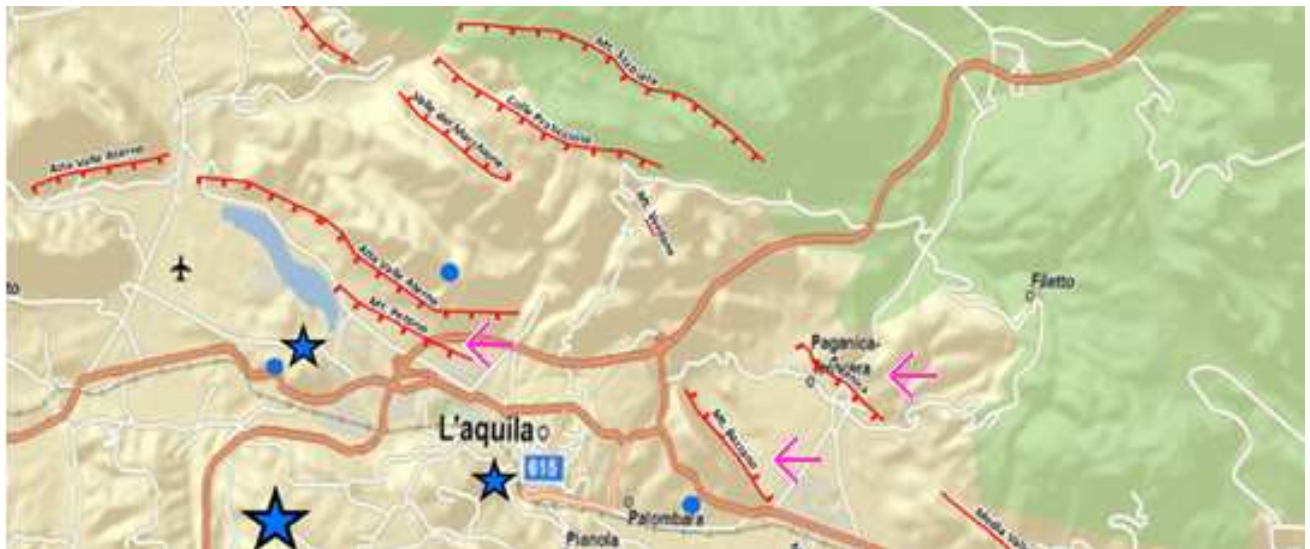
Figura 3.6. Faglie attive presenti nell'area dell'aquilano, nella zona più prossima alla città de L'Aquila. Sono evidenziate le faglie di Paganica, Bazzano e Pettino (Di Capua et al., 2009)
