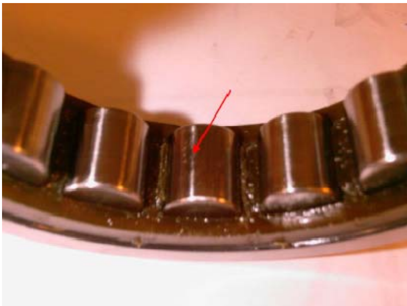
Figura 4.5: difetto sull'elemento volvente.
