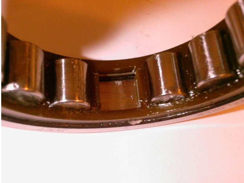
Figura 4.3: difetto sulla pista esterna.
