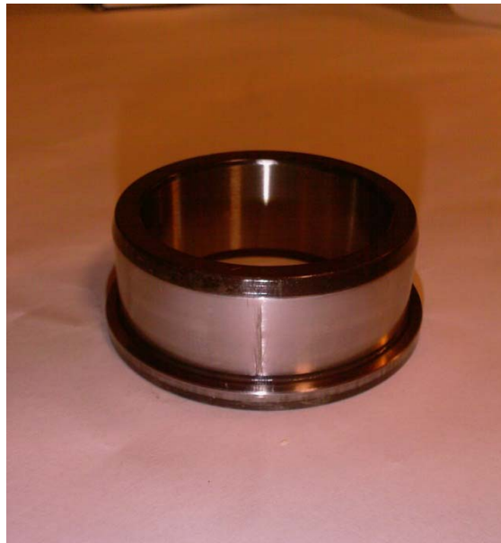
Figura 4.2: difetto sulla pista interna.
