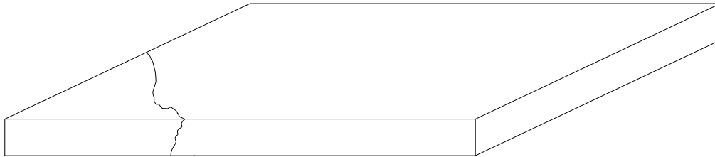
Fig. 2.45 Frattura non di tipo termico
