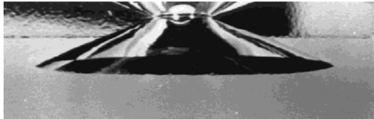
Fig. 9.7 Cono Hertziano generato in vetro sodico calcico sottoposto a carico di 40 kN
