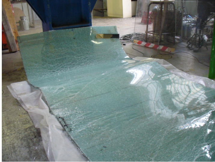
Fig. 3.3 Tipico comportamento a rottura di uno stratificato
