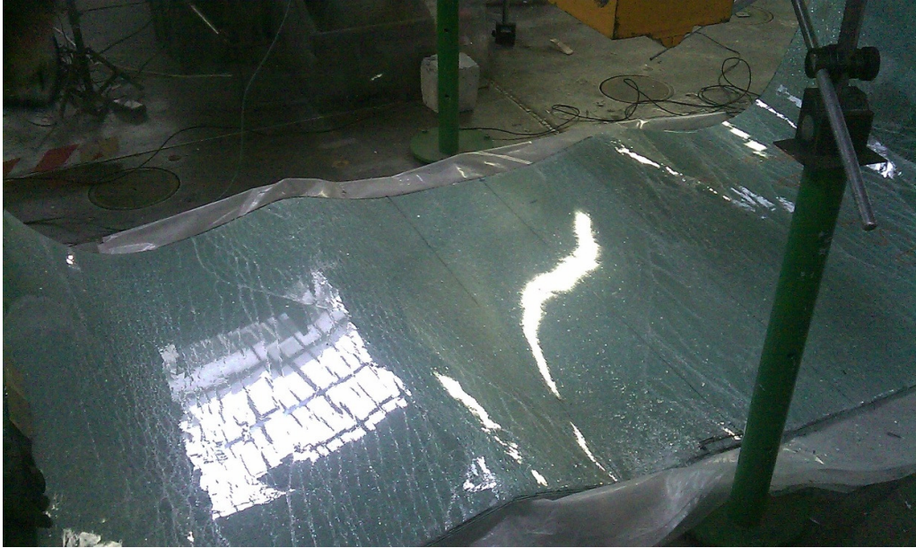
Fig. 6.21 Collasso con rottura vetro superiore della lastra n.2.
