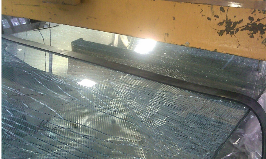
Fig. 6.25 Raggiungimento del collasso dello strato inferiore di vetro della lastra n.1
