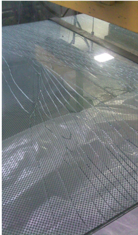
Fig. 6.20 Prima rottura lastra n.2 ; vetro inferiore
