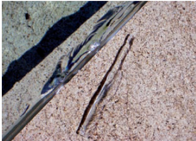
Fig. 2.27 Rottura vetro indurito in prossimità degli spigoli
