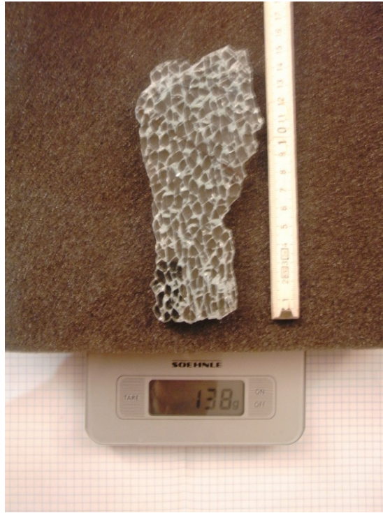
Fig. 6.36 Residuo ottenuto dalla rottura della lastra monolitica di facciata rinvenuto integro sotto il banco di prova e caduto dalla quota di 90 cm.
