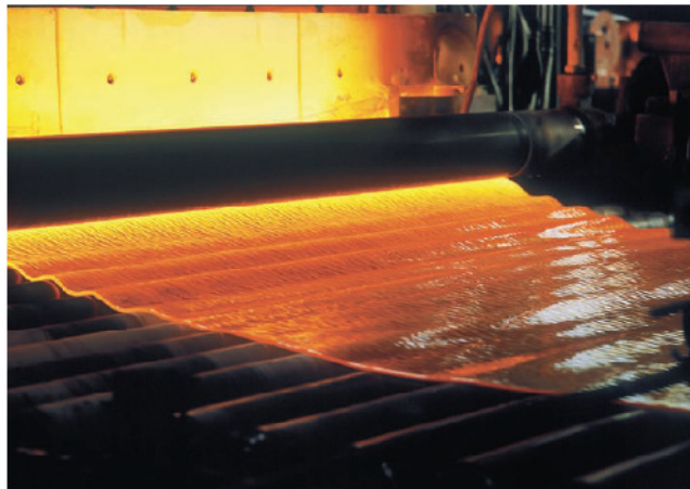
Fig. 2.11 Raffreddamento e taglio dei nastri di vetro
