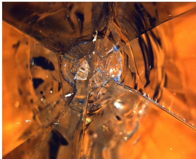
Fig. 10.10 Osservazione con Hertziano con microscopio ottico – Ingrandimento 20x
