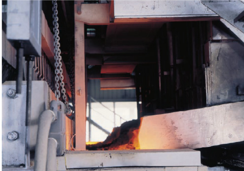
Fig. 2.10 Introduzione materie prime nella miscela vetrosa
