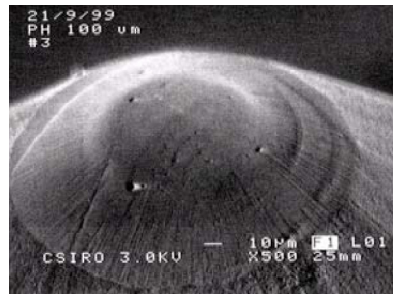
Fig. 8.7 Punta di un indentatore sferico conico
