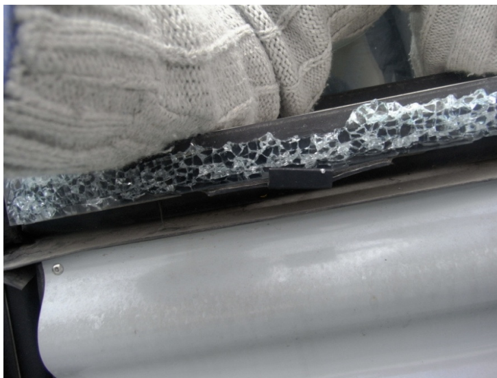
Fig. 6.7 Rottura del supporto di montaggio inferiore in alluminio (rottura mese di agosto 2009)
