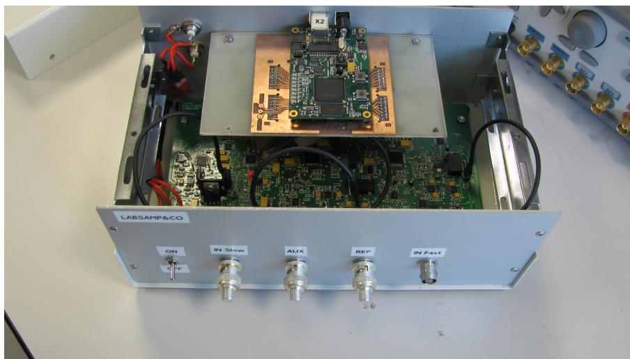
Figura 4.2: In figura viene presentato il case dello strumento progettato, privo della copertura superiore.
