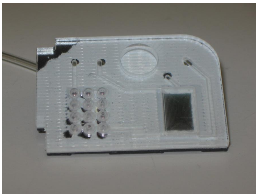
Figura 2.3 È riprodotto in figura un primo abbozzo di circuito microfluidico per l'estrazione del DNA da fluido organico; nella camera visibile sulla destra vengono aspirati e miscelati i reagenti. Il prodotto finale viene poi immesso nei pozzetti osservabili sulla sinistra, dove può avvenire l'analisi chimica vera e propria.
