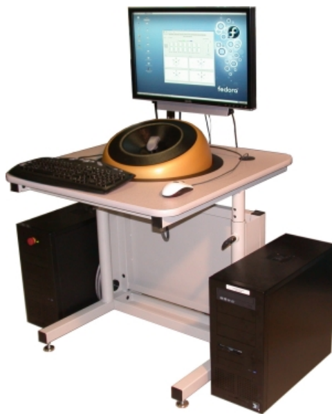
Figura 2.4: Device aptico a levitazione magnetica
