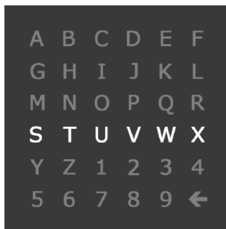
Figura 8 - Matrice 6x6 usata nel P300-speller come stimolo visivo; righe e colonne sono illuminate una alla volta in modo casuale.
