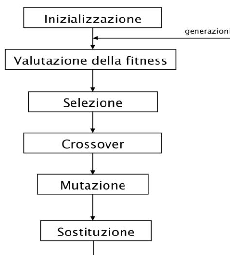
Figura 9 - Rappresentazione schematica di un algoritmo genetico con le sue fasi fondamentali.
