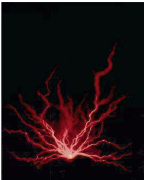
Figura 1.3: Immagine di streamers in scarica di tipo pulsed corona in liquido [Locke et al. 2006]
