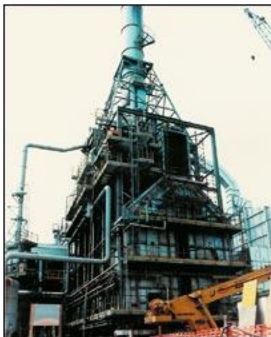
Figura 1.1: Forno di raffineria per visbreaking [www.gazzanigasrl.it]
