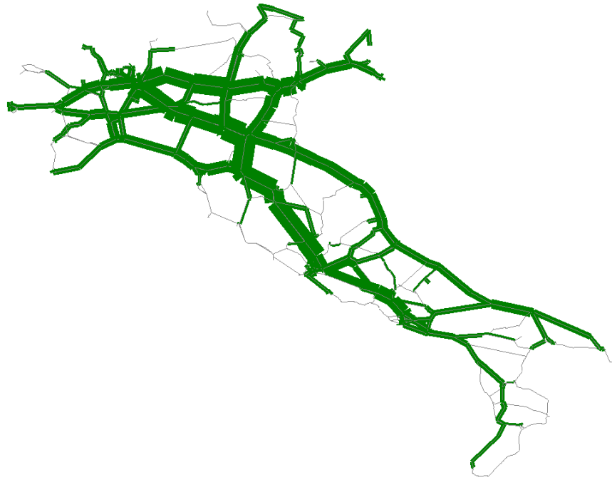
Figura 33 Flussi assegnati delle OD precedentemente non passanti per l'arco, assegnati nello scenario a regime
