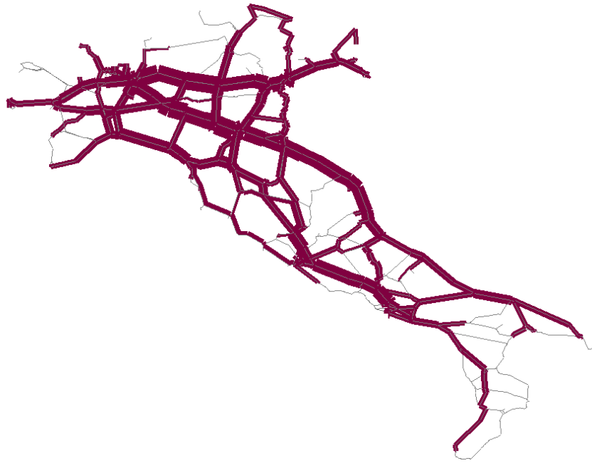
Figura 17 Flussi di traffico sulla rete completamente funzionante (scenario “zero”)
