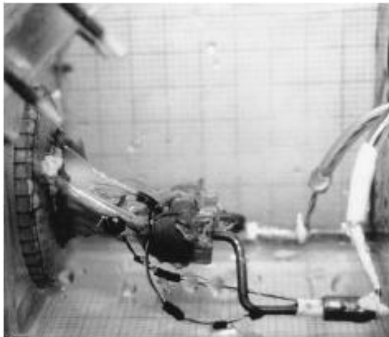
Figura 2.3 Immagine della camera ventricolare, in particolare del meccanismo di movimentazione dei muscoli papillari.
