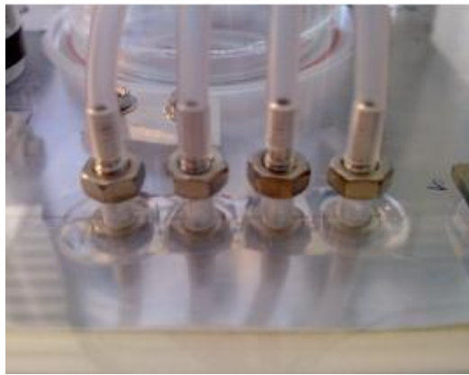
Figura 2.24 Interfaccia di collegamento per i tubi che controllano il movimento dei minicilindri.
