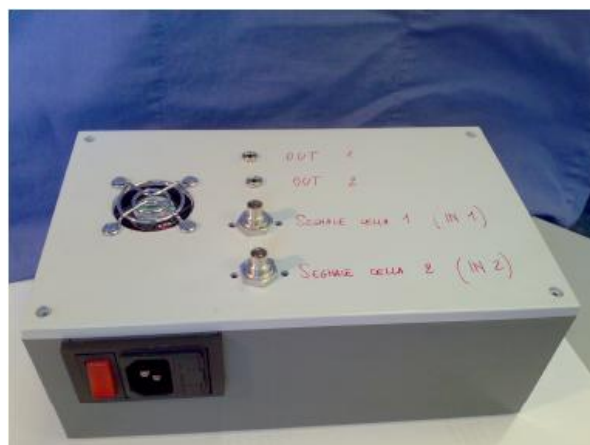
Figura 2.27 Centralina contenente il sistema di amplificazione del segnale proveniente dalle celle e alimentazione per le stesse: sul coperchio si possono osservare i due connettori per le celle di carico e i due connettori jack femmina per il segnale destinato alla scheda di acquisizione.
