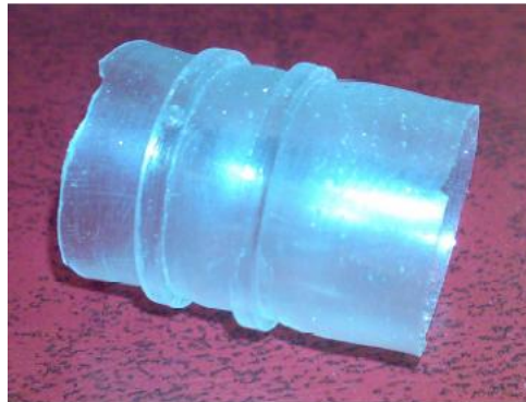
Figura 2.26 Camicia in silicone ottenuta con l'utilizzo del silicone bi componente ELASTOSIL® RT 601 US.
