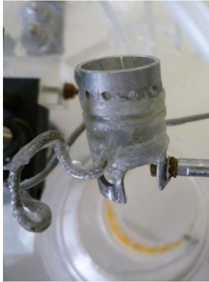
Figura 3.8 Sistema di afferraggio di un muscolo papillare con all'interno la cella di carico: sul sistema d'afferraggio è stata calzata una camicia in silicone per isolare la cella dall'ambiente acquoso esterno e per lo stesso motivo il cavo di trasmissione del segnale è stato ricoperto di silicone.
