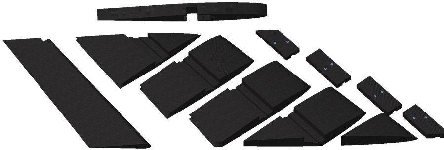
Figura 2.11.: Esploso dei settori della Deriva CAD
