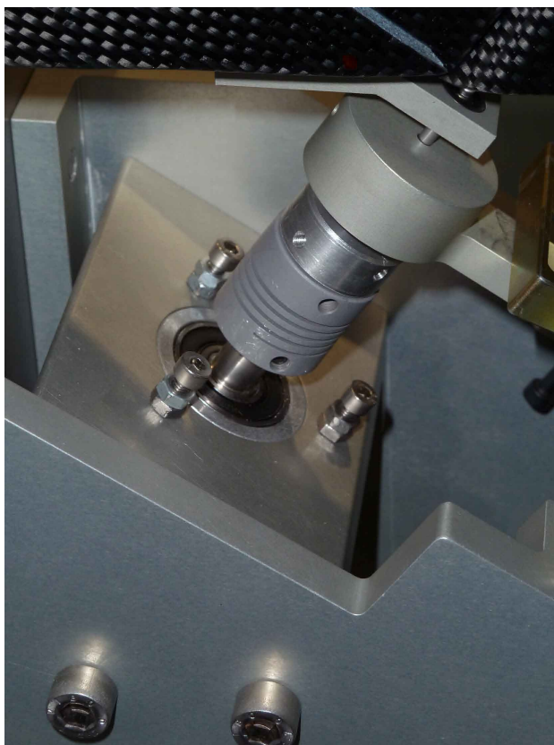
Figura 5.4.: Installazione dell'encoder Sick DSF60B
