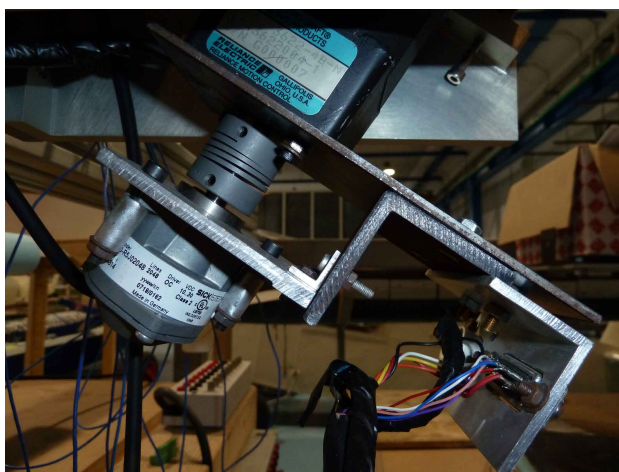
Figura 5.5.: Installazione dell'encoder Sick DKS40
