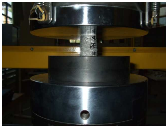
Figura 6.11: Posizionamento provini per prova di compressione.
