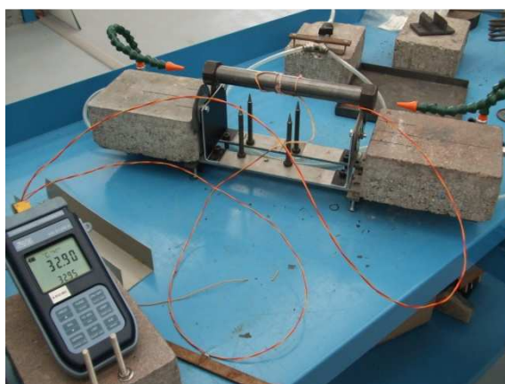
Figura 4.19: Tubo strumentato per lo studio dell'andamento termico.
