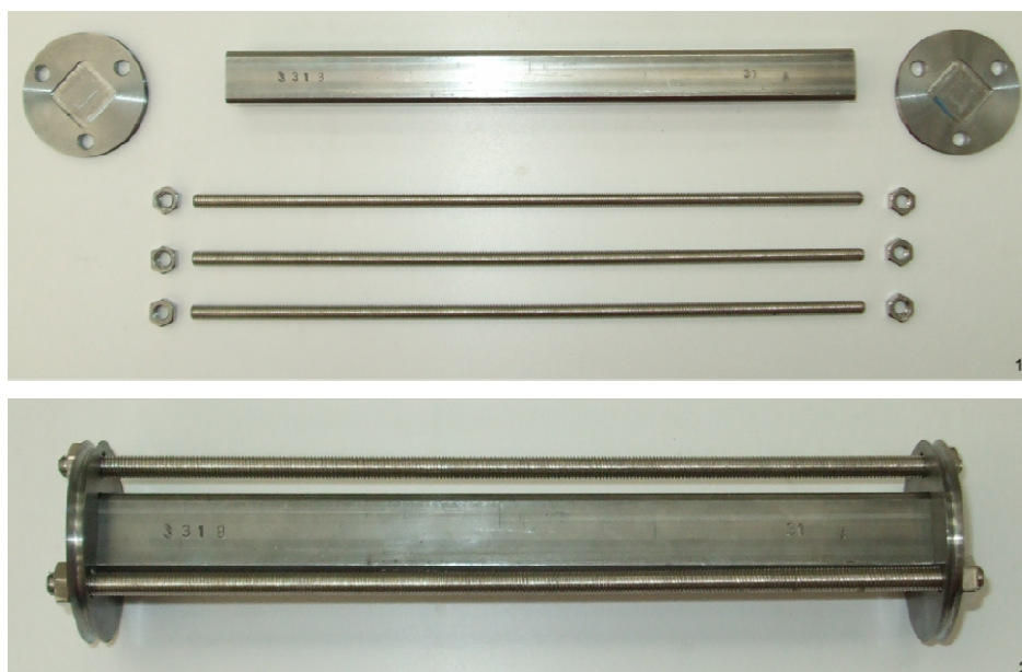
Figura 4.22: 1:esploso del sistema di chiusura del tubo quadro, 2: insieme del sistema di chiusura.
