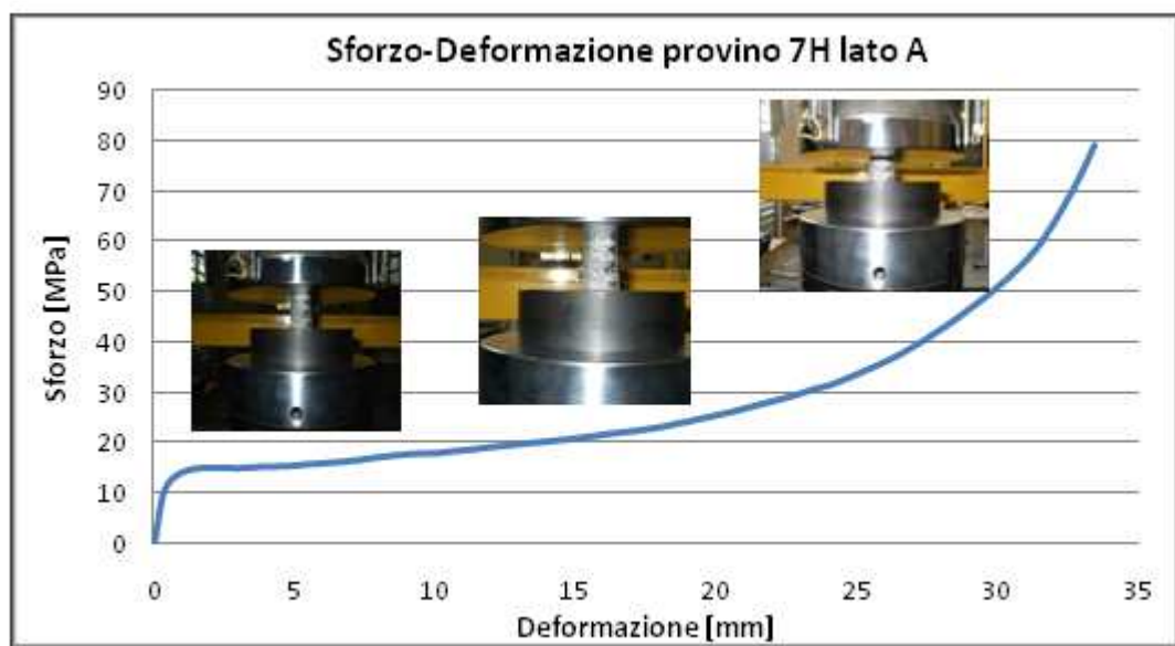
Figura 6.12: Grafico sforzo-deformazione per il provino 7H lato A.
