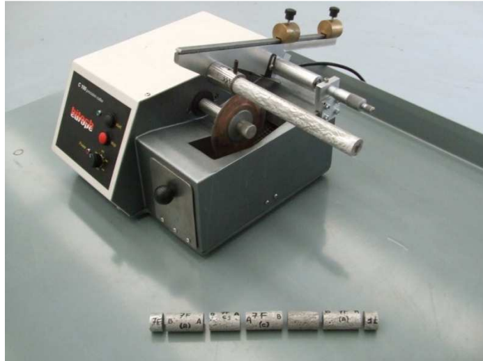
Figura 6.10: Troncatrice metallografica con provino sezionato.
