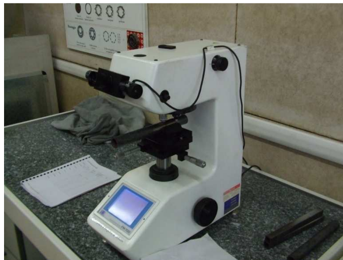
Figura 6.2: Prova di micro durezza sul tubo tondo.
