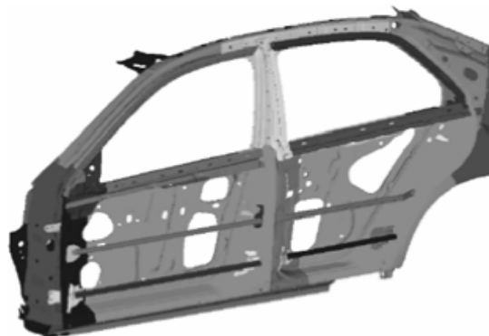
Figura 1.6: Barre longitudinali (tratto da [4]).
