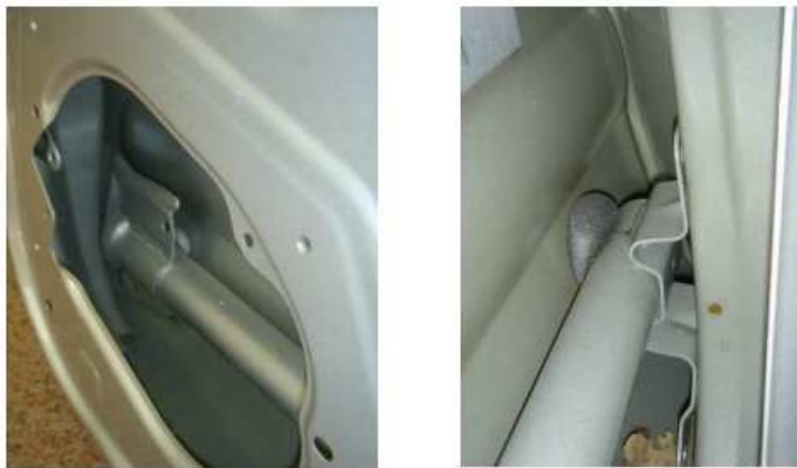
Figura 1.8: Barra tubolare Nissan Pathfinder diametro 31.8 mm spessore 2.6 mm.
