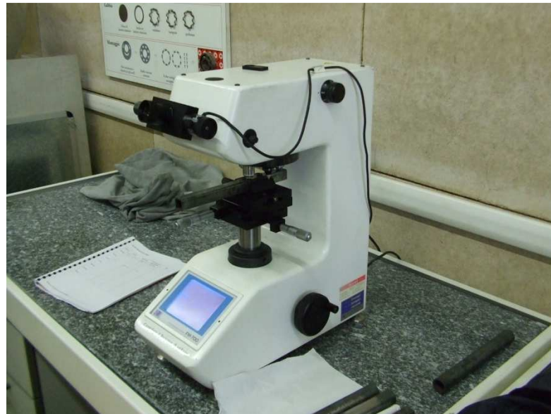
Figura 6.5: Prova di micro durezza sul tubo quadro.
