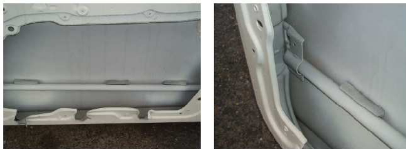
Figura 1.4: Esempio di geometria tubolare, barra laterale Lancia Y.
