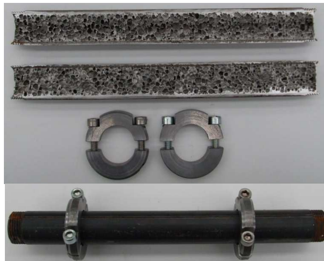
Figura 5.20: Sezione tubo tagliato mediante AWJ e riassetaggio mediante anelli.
