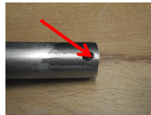
(c) Particolare del cedimento all'apice dello stelo
