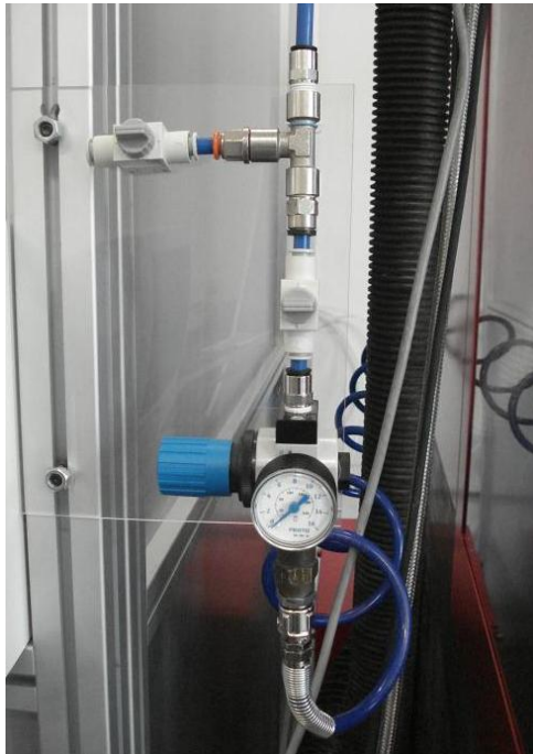
(a) Sistema di controllo della pressione
