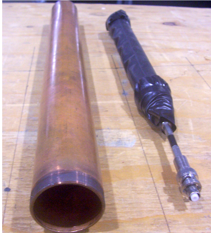
Figura 2.13: Rivelatore BF_3 e relativo cilindro schermante di rame (altezza: 40 cm, diametro: 5 cm).
