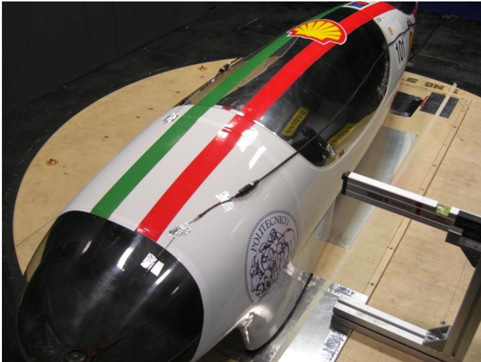
FIGURA 50 - VETTURA CON SONDE A FILO CALDO
