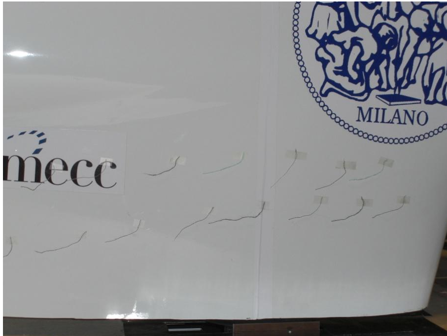
FIGURA 63 - VISUALIZZAZIONE CON FILI DI LANA A 6M/s
