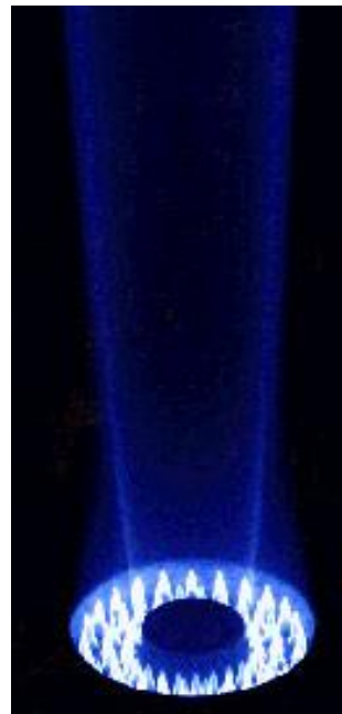
Figura 6.5: Bruciatore con fiamme pilota
