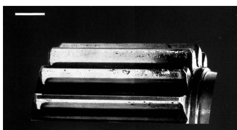
Figura 1.3 – A sinistra: ingranaggio con danneggiamento superficiale. In queste condizioni l'elemento è ancora in grado di funzionare, ma ulteriori danneggiamenti potrebbero portare alla frattura di un dente. A destra: Danneggiamento microscopico sulla via di corsa di un cuscinetto a rotolamento. L'immagine è rappresentativa dell'inizio della fessurazione, che porta ai risultati catastrofici di figura 1.1
