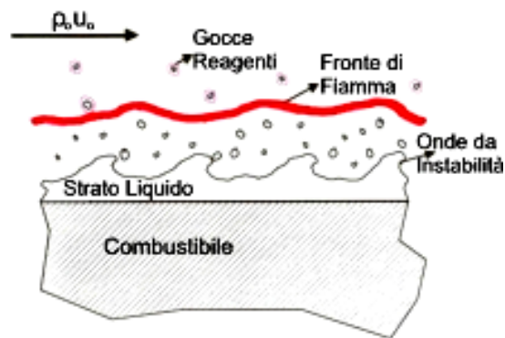
Figura 2.6. Schema del meccanismo di instabilizzazione di combustibili bassofondenti.
