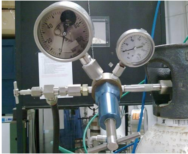
Figura 4.5. Dettaglio del riduttore della bombola di ossigeno. Sono visibili i manometri e la valvola di regolazione del flusso.
