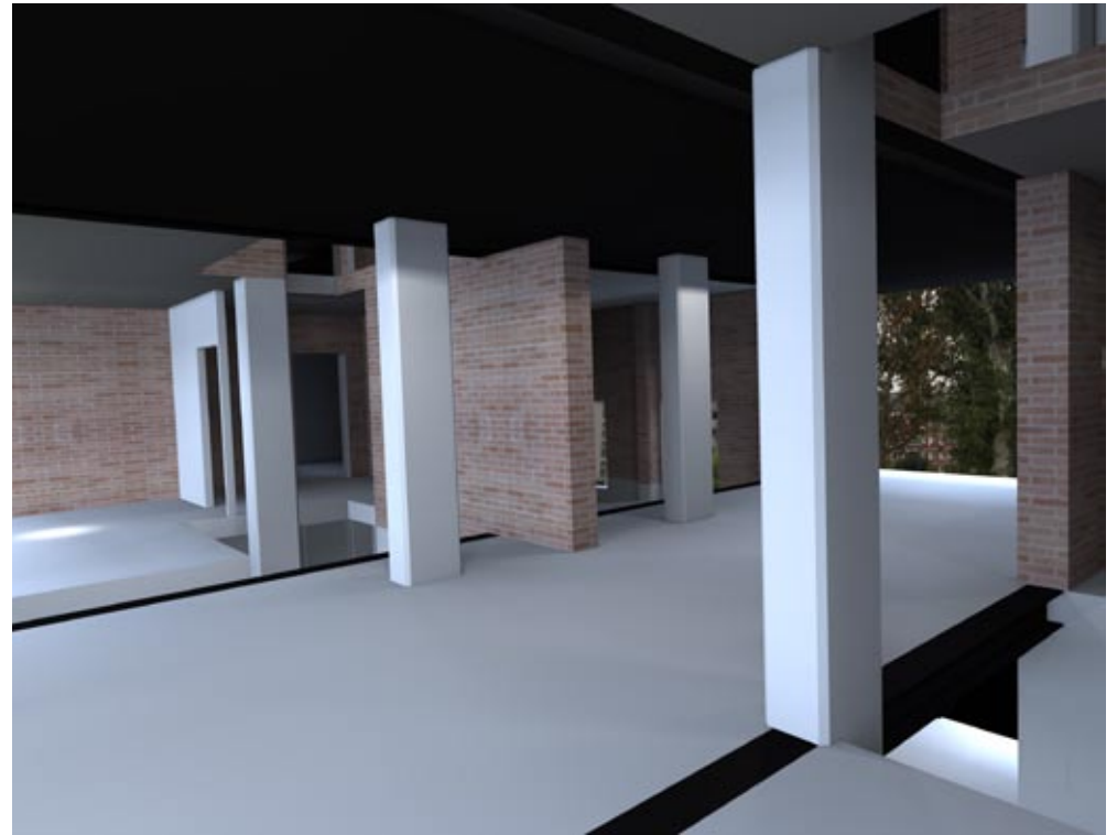
7. Particolare della struttura degli alloggi al primo piano: le parti esitenti sono individuate dal materiale originario, il mattone a vista
