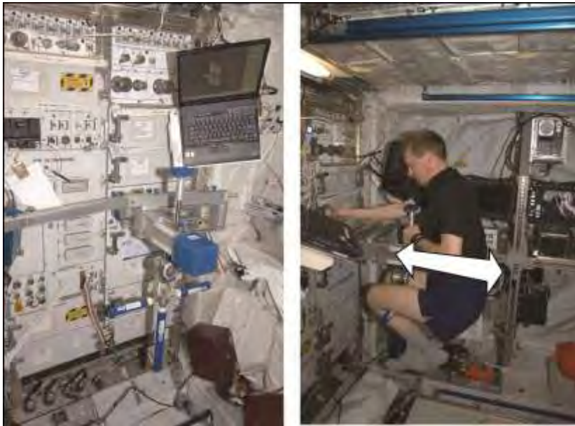
Fig. 72. Dispositivo di accelerazione lineare per la misurazione della massa corporea, sull'ISS.
