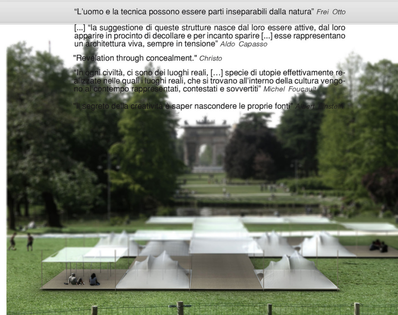
Prima sequenza: la cellula base prende forma , l'utente inserisce i cilindri di alluminio estruso a suo piacere al fine di dare forma allo spazio chiuso e aperto. Seconda sequenza: la cellula prende forma attraverso l' abbassamento manuale della membrana tessile. L' annessione di due o più cellule avviene con l'inserimento di un portale in alluminio al confine tra queste.
