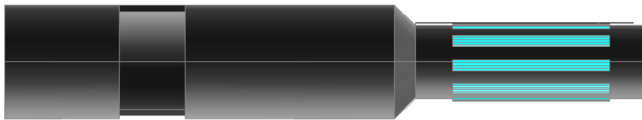
Fig.4.5 - Visione del contatto tra maschio e lamelle a maschio e femmina uniti
