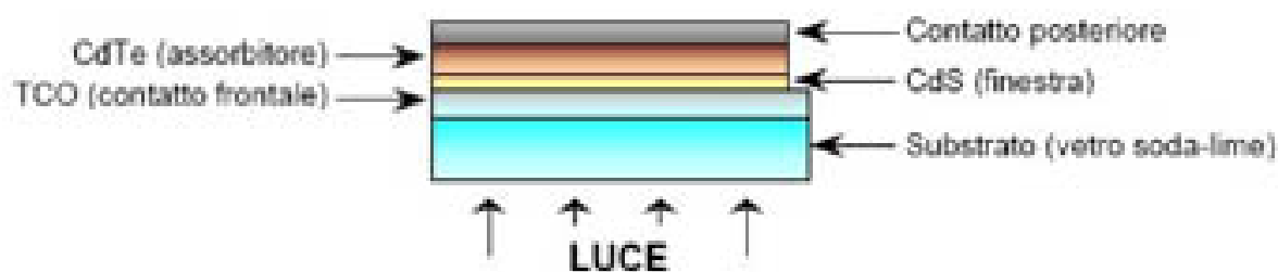
Fig.1.6 – Strati costituenti una cella al tellurio di cadmio. [3]
