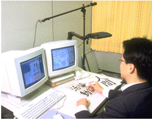
Figura 59 - Prime sperimentazioni con la TeamWorkstation. Nella foto Hiroshi Ishii simula una lezione di ideogrammi. Si possono distinguere: il monitor dove visualizza il piano della sua scrivania e l'utente con cui comunica e la camera che riprende la scrivania
