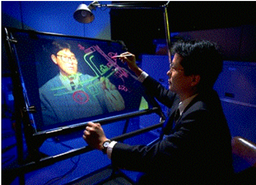
Figura 61 - Secondo prototipo della ClearBoard: la lavagna trasparente è stata sostituita con un monitor in cui è possibile scrivere e ribaltare l'immagine
