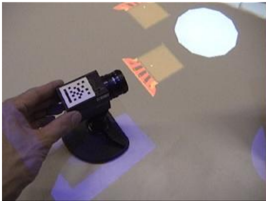
Figura 64 - Particolare di uno degli strumenti utilizzati per visualizzare le immagini digitali bidimensionali sul tavolo, nel formato tridimensionale proiettato sulla parete. Da notare il simbolo posto sul modello della camera per permettere alla camera posta sul soffitto di riconoscere l'oggetto.
