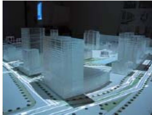
Figura 123 - Immagine del secondo tipo di modelli fisici utilizzati con il LPT durante una simulazione delle ombre. I modelli sono creati sovrapponendo diversi strati per dare il senso dell'altezza degli edifici marcando il numero di piani
