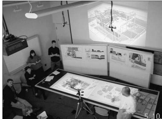
Figura 68 - Panoramica del LPT: sul tavolo sono disposte mappe e modelli, l'I/O bulb sospeso proietta sul tavolo e riprende la scena per analizzarla, un'altro proiettore proietta sulla parete la scena tridimensionale digitale del modello
