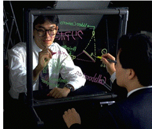
Figura 60 - Primo prototipo della ClearBoard. I due collaboratori condividono lo stesso spazio di lavoro, ma uno vede l'operato dell'altro capovolto
