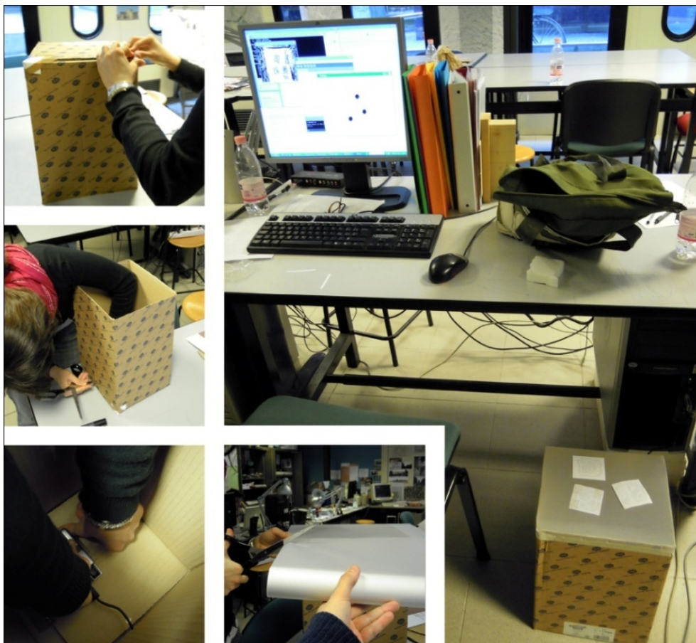
Figura 93 - Foto scattate durante la costruzione del primo prototipo: dalla preparazione della scatola ai test al computer con il software reacTIVision e i fiducial marker
