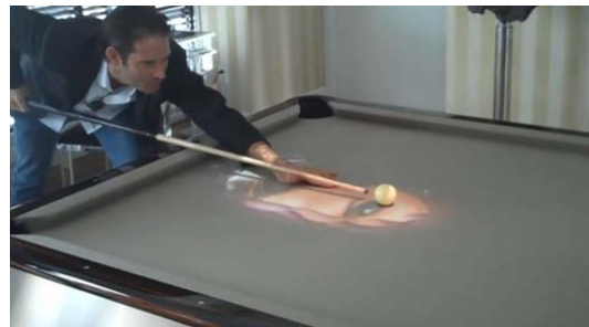
Figura 95 - Tavolo da Pool digitale: il software analizza la posizione della stecca e l'intensità del tiro, interagendo sulle palle proiettate
