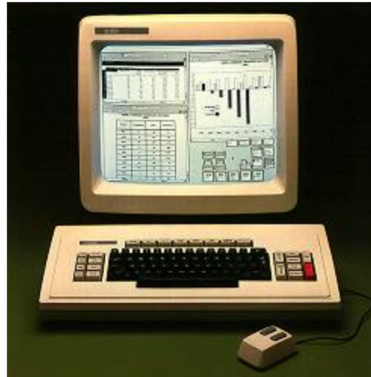
Figura 17 - Xerox 8010 Information System, commercializzato nel 1981: come si può notare si vedono solo monitor e tastiera, poiché l'hardware era composto da diverse workstation in serie
