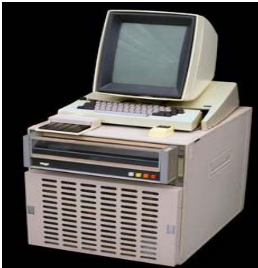
Figura 16 - La prima Workstation progettata allo Xerox PARC nel 1973: da notare le dimensioni del computer sottostante
