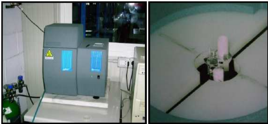
Figura 4.1 : Esempio di un moderno calorimetro a scansione: a) fornace; b) particolare delle coppelline in allumina
