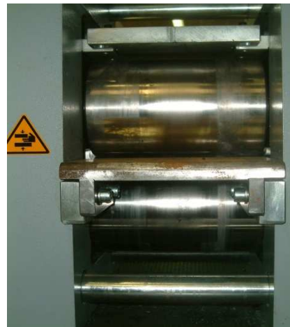
Figura 5. 6 – 5. 7: Laminatoio utilizzato e particolare dei rulli di laminazione
