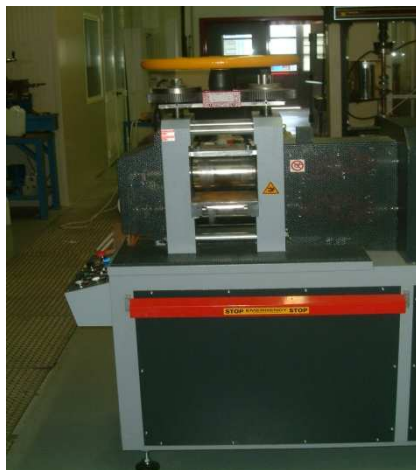
Figura 5. 6 – 5. 7: Laminatoio utilizzato e particolare dei rulli di laminazione
