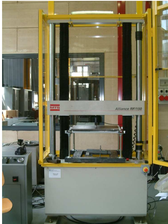
Figura 4. 13: Macchina universale elettromeccanica MTS Alliance RT/150
