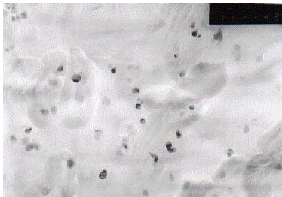
Figura 3.1 Esempi di carburi di vanadio di dimensioni nanometriche osservati mediante microscopio elettronico a trasmissione (TEM) [11]
