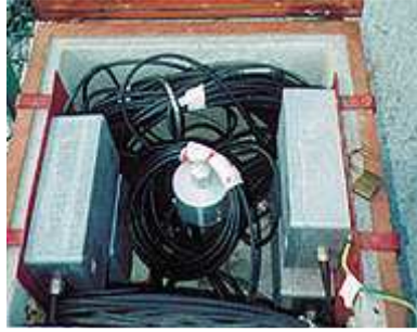
Figura 34: Testa di un tubo iclinometrico, attrezzato con sonde fisse
