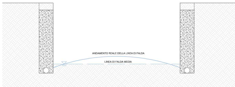
Figura 36: Schema di funzionamento di trincee drenanti
