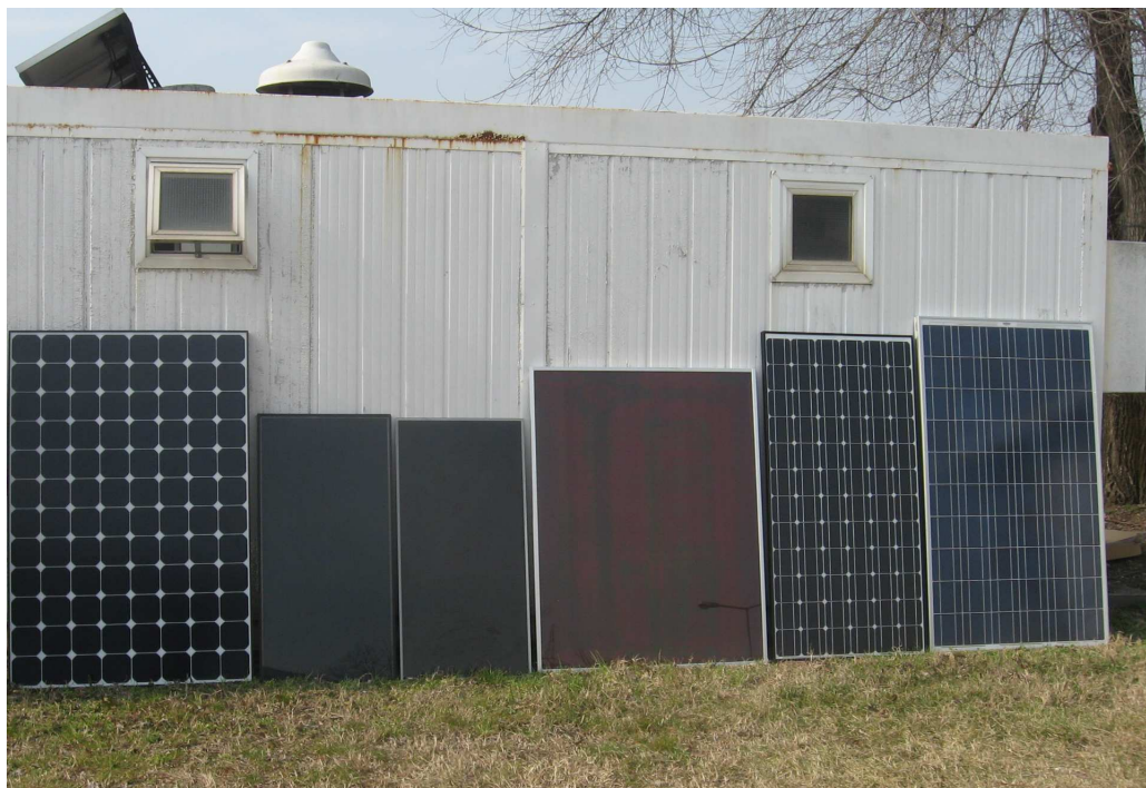
Figura 2.3 – Moduli fotovoltaici costituenti le sei sezioni dell’impianto sperimentale monitorato
