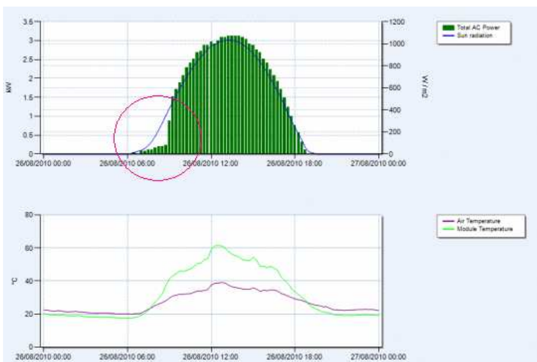
Figura 4.27 – Andamento della potenza in corrente alternata rispetto al livello di irraggiamento
