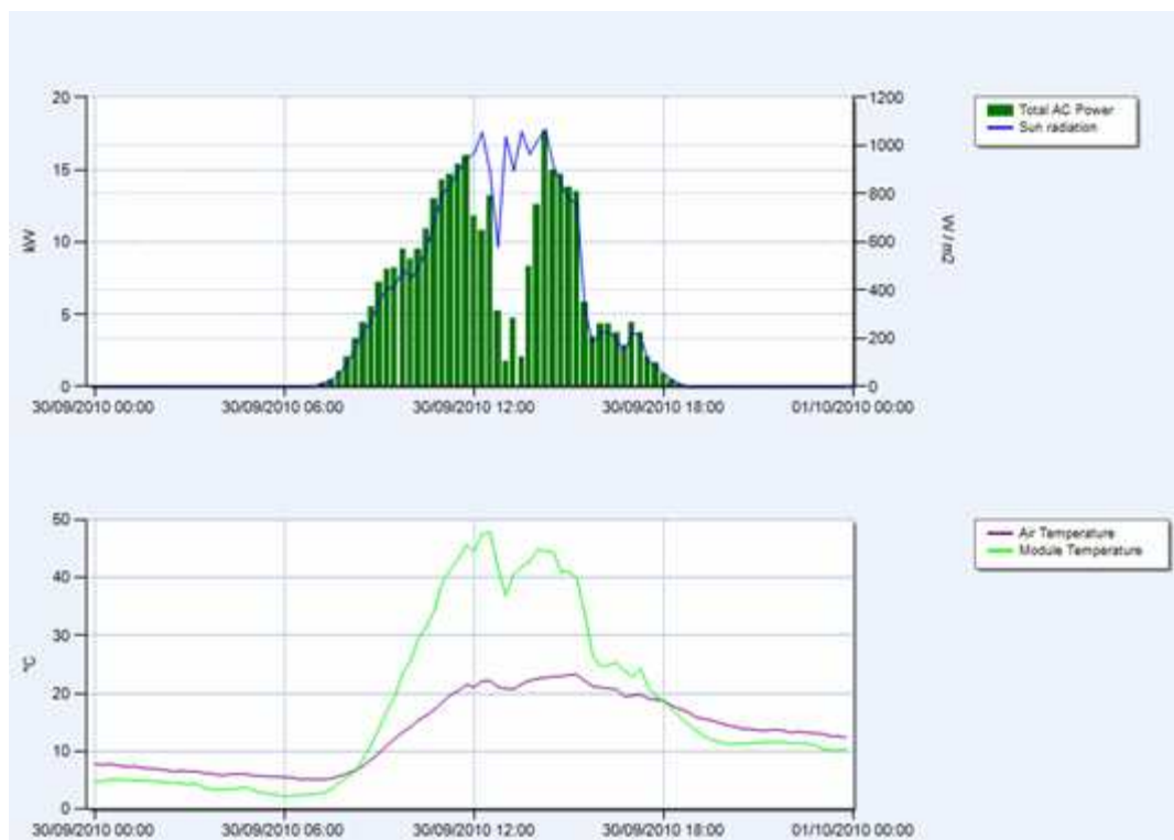
Figura 4.29 - Andamento della potenza in corrente alternata rispetto al livello di irraggiamento.
