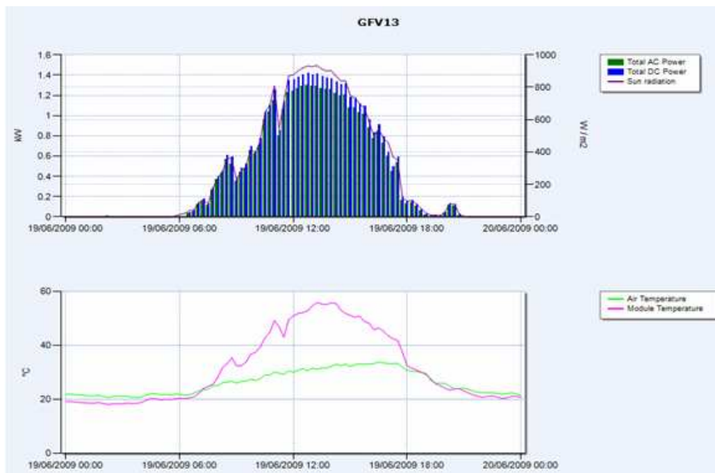
Figura 3.3 Esempio di monitoraggio di un impianto fotovoltaico: dati di potenza e meteo, misurati in una giornata estiva
