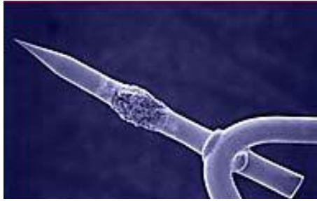
Fig. 2.3 Immagine del filamento di una Field Emission Gun (FEG). Le dimensioni sono di poco meno di 1 \mu\text{m} con un raggio di curvatura di 15 nm.
