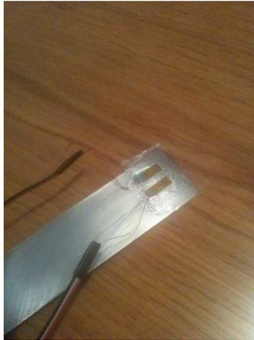
*Figura 5.18 – Coppia di estensimetri incollata al provino*
