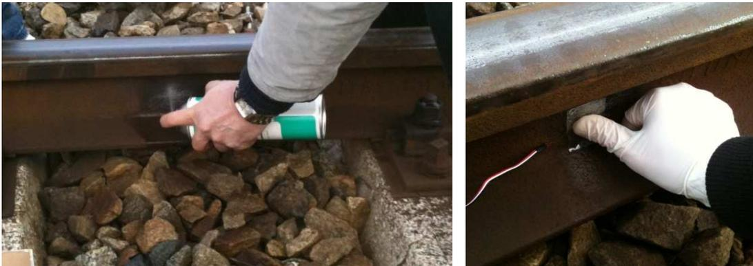
*Figura 6.11 – Sgrassaggio della superficie e incollaggio degli estensimetri*
