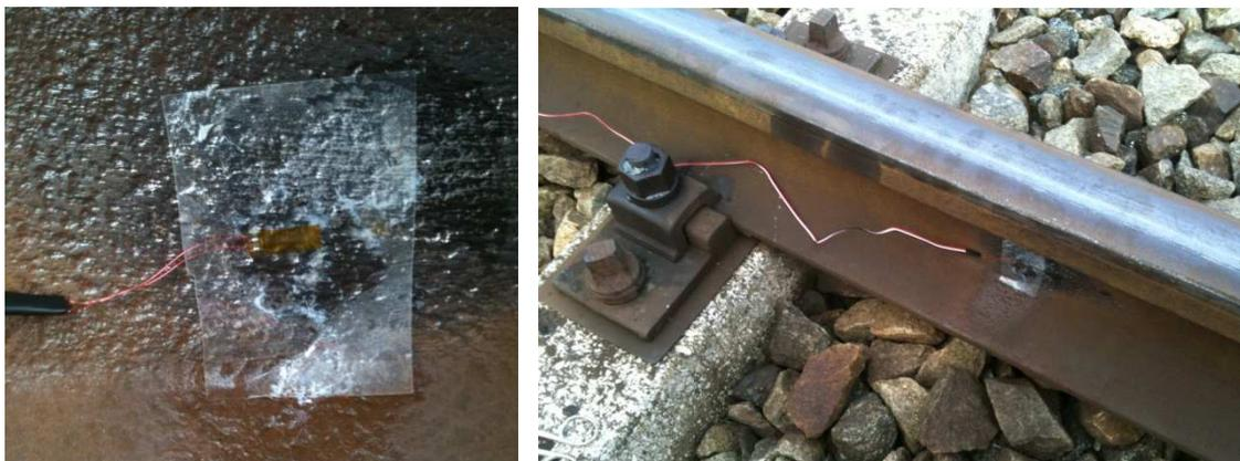
*Figura 6.12 – Estensimetri incollati al gambo della rotaia*
