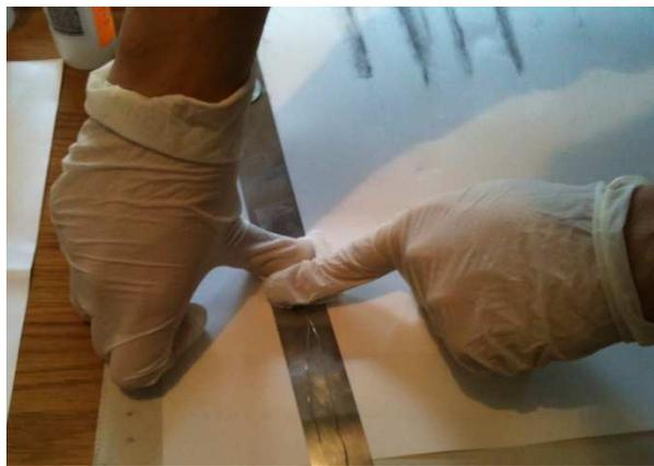
*Figura 5.17 – Azione di pressione sopra l'estensimetro*
