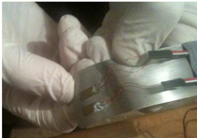
*Figura 5.23 – Azione di flessione sul provino*
