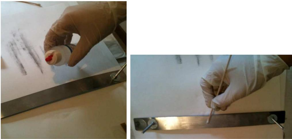
*Figura 5.13 – Applicazione del condizionatore e pulitura del provino*
