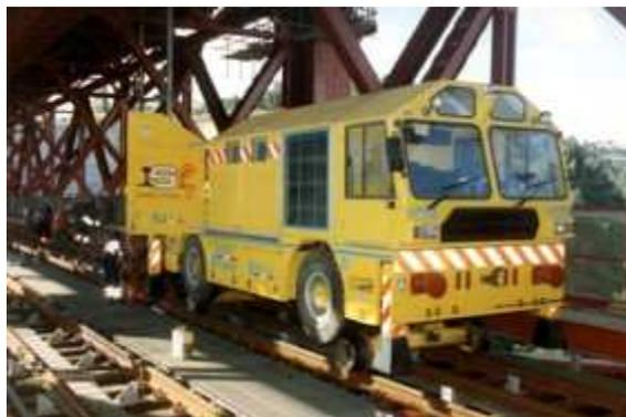
*Figura 3.15 – Macchina saldatrice semovente strada - rotaia*
