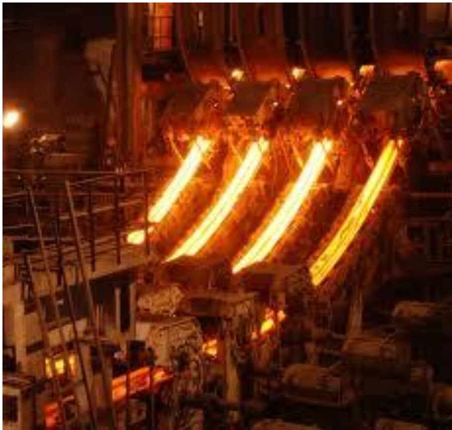
Figura 7.13 Fotografia di una macchina per la colata continua di blumi
