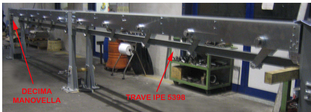
Figura 6.8: Set-up della prova: posizionamento dell'inclinometro sulla decima manovella
