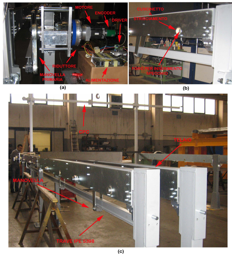
Figura 6.1: Apparato sperimentale del prototipo: (a) motore e riduttore, (b) foro per inserimento del riflettore, (c) cinematico del prototipo
