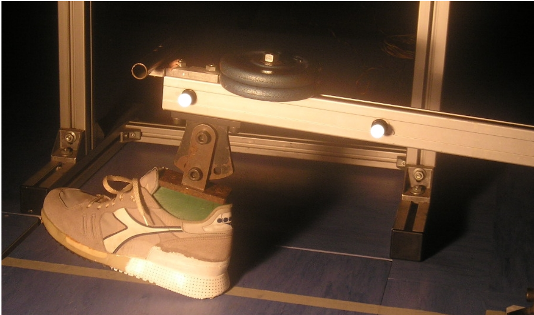
Figura 21: il protocollo di acquisizione della cinematica ha previsto l'applicazione di due soli marker rifrangenti sul braccio dell'IS per la cattura della sua escursione angolare.
