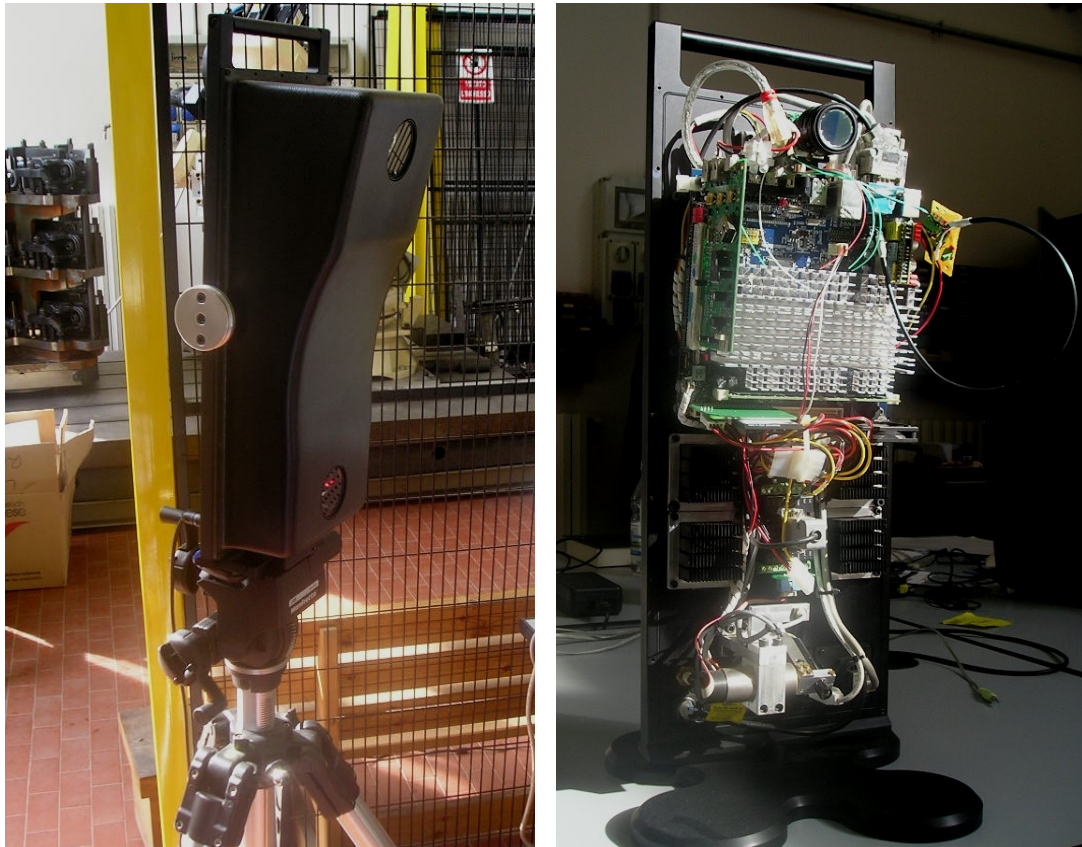
Figura 25: lo scanner a lama di luce laser ( \lambda = 650 \text{ nm} ) utilizzato per l'acquisizione della geometria della calzatura. La risoluzione spaziale con la calibrazione adottata è di 0.5 \text{ mm} ; nel sensore è integrato un filtro passabanda centrato sulla frequenza corrispondente a \lambda ( f_{PB} = 4.612 \cdot 10^{14} \text{ Hz} ), utile ad escludere interferenze dovute a radiazioni elettromagnetiche di differente contenuto energetico. Indipendentemente da questo accorgimento hardware , le scansioni sono state eseguite in ambiente riparato in modo tale da limitare a priori i disturbi della radiazione ambientale solare. Il sistema di irradiazione è assistito da un motore in continua che controlla il beccheggio della sorgente di luce laser; l'albero di tale motore è accoppiato con un encoder per una trasduzione quantizzata della sua rotazione. I comandi al motore vengono impartiti dall' hardware interno (a destra), una mini EPIA con sistema operativo custom Linux . L'operatore interagisce con lo scanner attraverso un'interfaccia grafica su touch screen , tramite la quale è possibile regolare i parametri di acquisizione.
