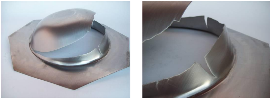
7.10 - Manufatto ottenuto con i parametri relativi al secondo test.
