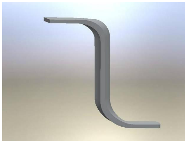
5.7 – Rappresentazione grafica della sezione angolare della vaschetta in 439 M
