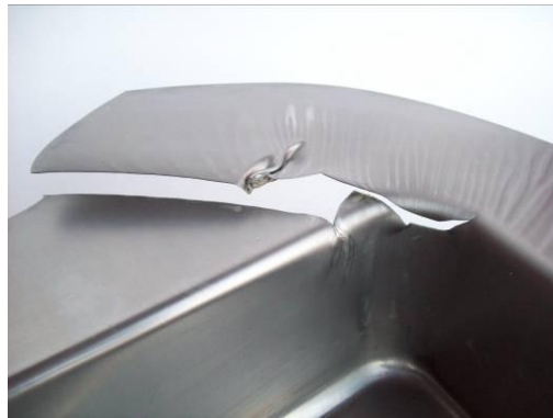
5.26 - Particolare di un punto di rottura del pezzo realizzato in ferritico.
