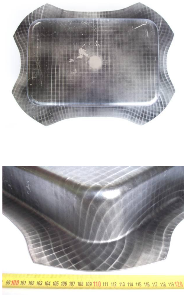
5.6 – Immagini del flusso di materiale di una vaschetta di 439 M
