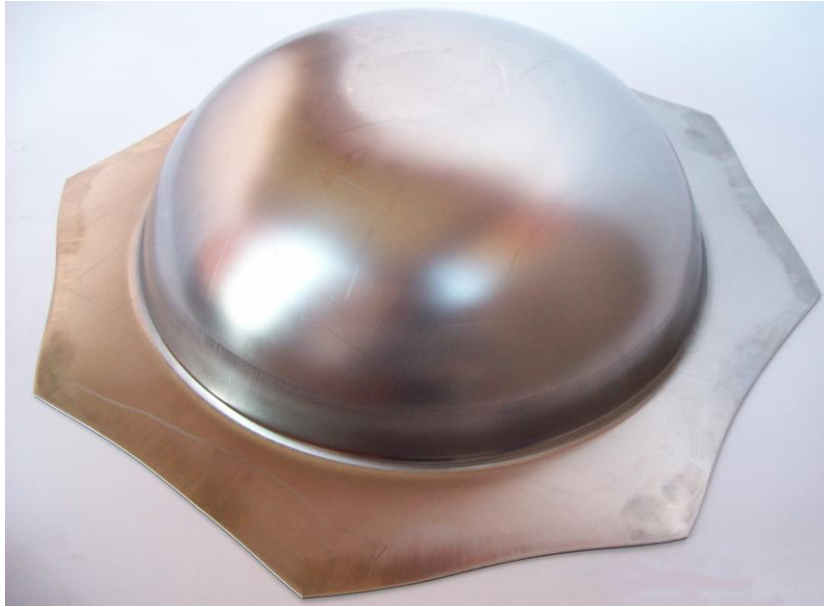
5.42 - Manufatto ottenuto in austenitico.
