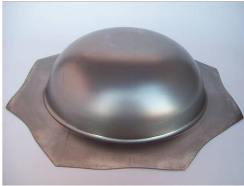
7.7 - Manufatto ottenuto con i parametri relativi al secondo test.
