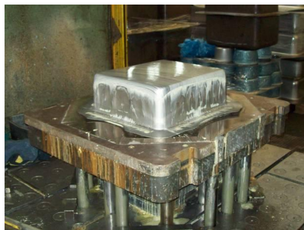
5.23 - Particolare dello stampo utilizzato.
