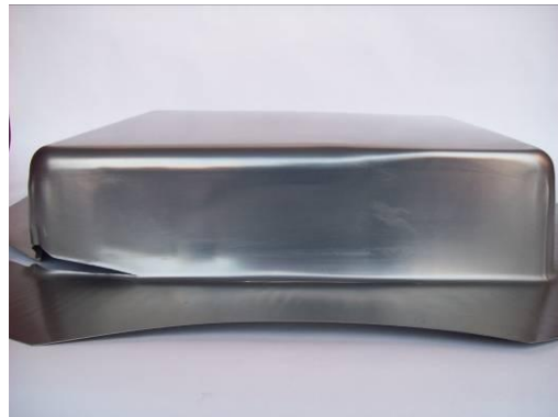
7.4 - Manufatto ottenuto con i parametri relativi al terzo test.
