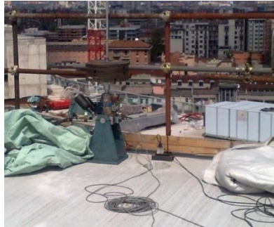
Figura 6.3.1 Attuatore oleodinamico utilizzato per il forzamento
