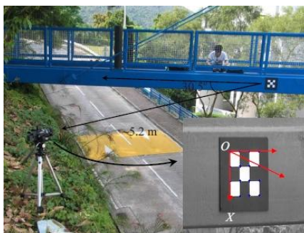
Figura 1.3.4 Target applicato alla struttura in analisi (Immagine tratta dal lavoro di C.C.Chang, M.ASCE, e X.H.Xiao).
