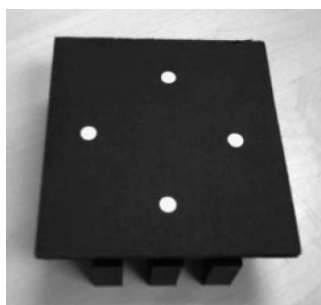
Figura 1.3.3 Target utilizzato per tracciare la posizione della struttura (Immagine tratta dallo studio effettuato da Yoshio Fukuda, Maria Q. Fengy e Masanobu Shinozuka)
