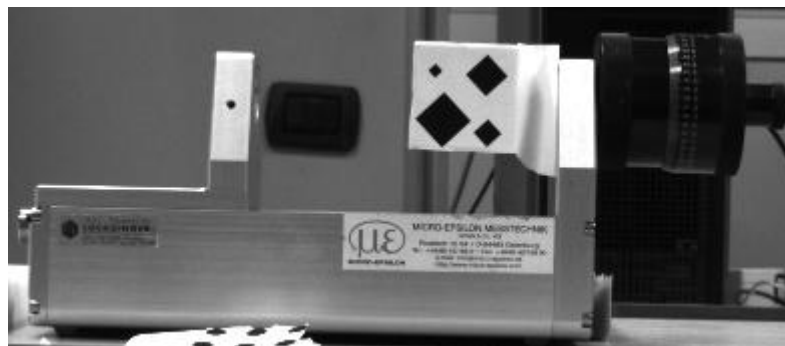
3.2.1 Micrometro utilizzato per imporre lo spostamento al target
