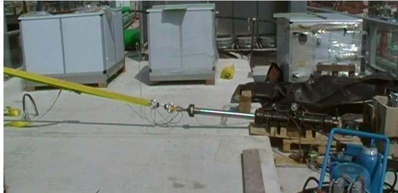
Figura 5.2.3 Pistone oleodinamico utilizzato per applicare il carico in B
