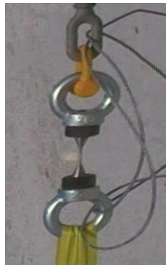
Figura 4.3.3 Provino messo in trazione
