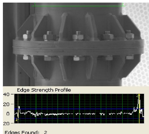
Figura 5.3.3 Determinazione del diametro della trave in pixel
