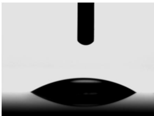
Fig. 5.2: Bagnabilità della muscovite. E'visibile la siringa dalla quale è stata depositata una goccia di acqua MilliQ con volume pari a 2\mu\text{l} . La misura è stata ripetuta per ottenere una statistica significativa del valore dell'angolo di contatto. La media di questi valori permette di determinare \theta = 32^\circ .
