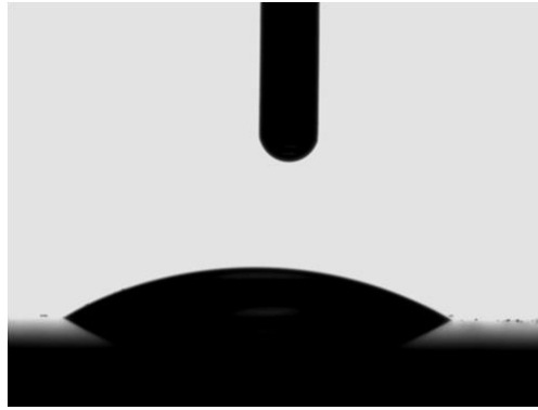
Fig. 5.4: Bagnabilità del substrato in silicio. Volume goccia 2\mu l , \theta = 29^\circ .
