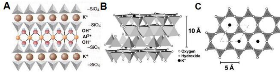
Fig. 5.1: Struttura cristallina della muscovite ( KAl_2(OH)_2AlSi_3O_{10} ): struttura a strati in cui è visibile un pacchetto (A), spessore di ogni strato, composto da piani di tetraedri con orientazioni opposte uniti da unità ottaedriche. Strati adiacenti sono legati gli uni agli altri da ioni K^+ , situati nelle cavità tra i tetraedri. Il clivaggio produce due superfici piatte a livello atomico in cui solo metà delle cavità sono occupate da questi ioni (C) poiché solo una cavità su due è carica negativamente.
