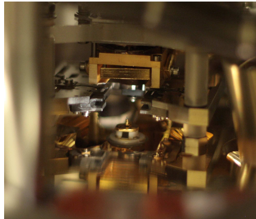
Figura A.2: Punta metallica alloggiata sullo scanner: la punta è rivolta verso l'alto e scansiona la superficie posta di fronte ad essa e rivolta verso il basso.
