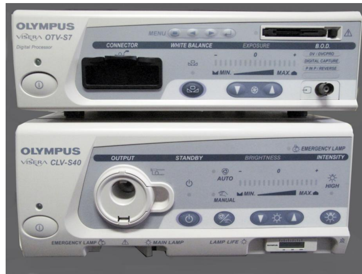
Figura 3.35: colonna per illuminazione Olympus Visera CLV-S40 (sotto) e colonna per immagini Olympus Visera OTV-S7(sopra).
