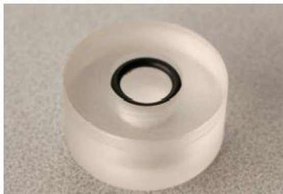
Figura 3.13: Boccia porta lente completa di cava e guarnizione O-Ring O2037.
