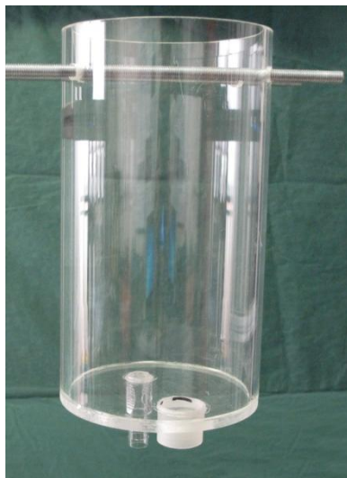
Figura 3.27: fotografia del reservoir di precarico atriale.
