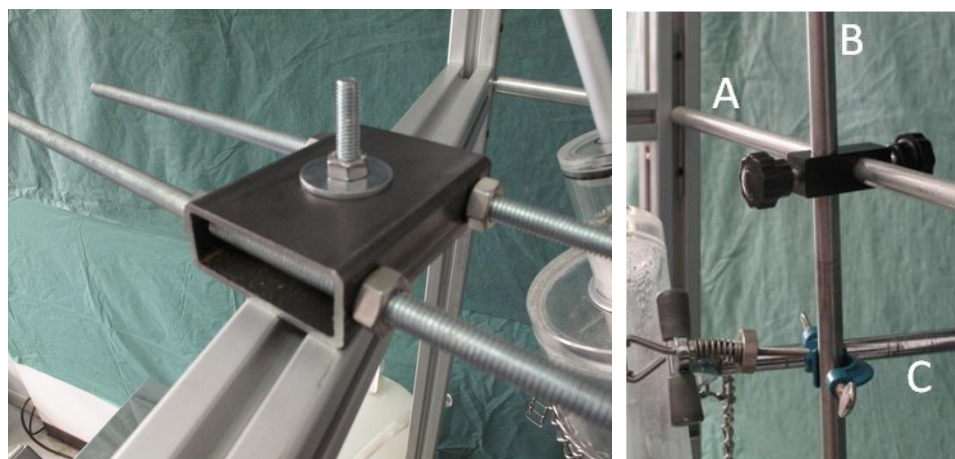
Figura 3.30: dettagli del sistema di regolazione della struttura portante. Sinistra – elemento di connessione tra la guida trasversale ed il reservoir atriale; il foro centrale permette la rotazione e la traslazione del componente. Destra – sistemi a vite di sostegno per il fissaggio relativo delle aste di sostegno del postcarico.
