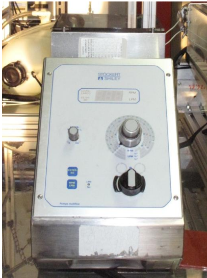
Figura 3.11: pompa peristaltica utilizzata in fase di innesco del banco prova.
