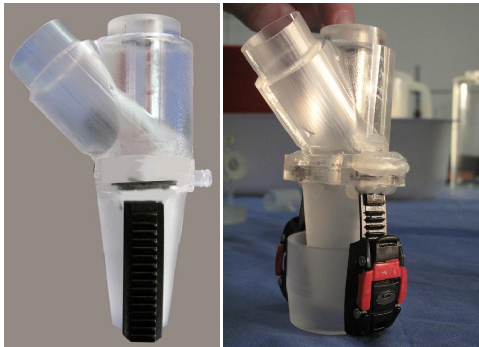
Figura 3.22: fotografie dei componenti del sistema di connessione aortico. Alto – Cono esterno con attacchi dei cricchetti. Sinistra – Cono interno con raccordo di uscita. Destra – Assieme.
