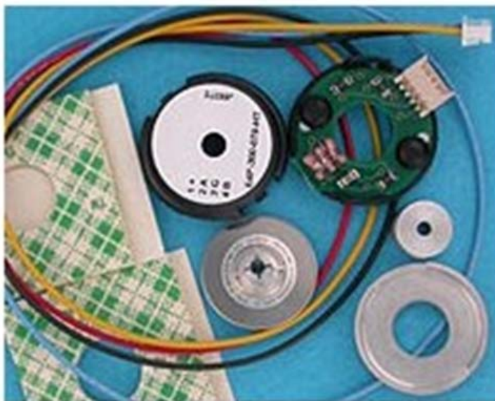
Figura 3.2.8 Encoder in quadratura Easy Roller 300 CPR 2
