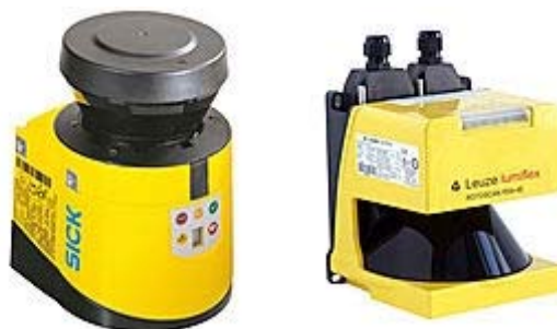
Figura 2.2.5 Due esempi di scanner laser. Nella calotta nera è presente lo specchio rotante mentre nella parte gialla l'elettronica e la coppia diodi-laser
