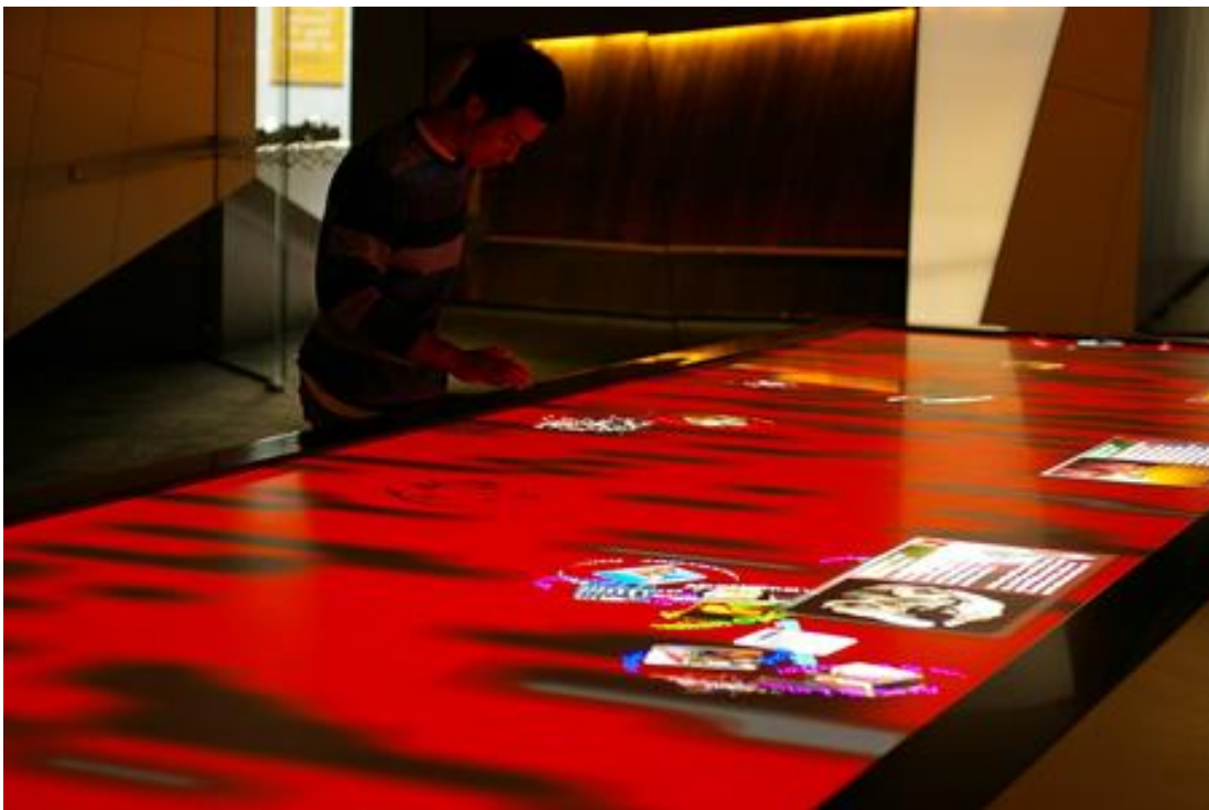
Figura 2.8 Il tavolo multi-touch Serendipity al piano terra dell'Eureka Tower di Melbourne. Gli agglomerati che si trovano al centro del tavolo fluttuano lungo la superficie e quando un utente li tocca, si materializzano le finestre informative che si vedono sulla parte destra dell'immagine.
