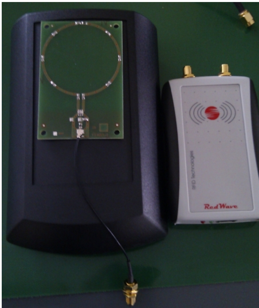
Figura A.2: Confronto tra il lettore precedente, a destra, e quello attuale, a sinistra. Si può notare l'antenna integrata appoggiata sulla scocca.
