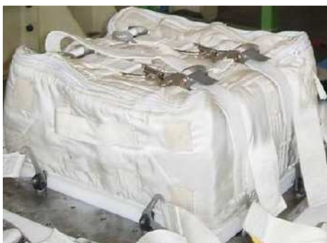
Figura 4.1 CTB singola nella configurazione di test in IABG e la relativa schematizzazione (immagini fornite da Thales Alenia Space)
