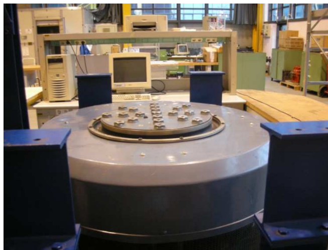
Figura 2.5 Tavola vibrante e sistema di acquisizione dati
