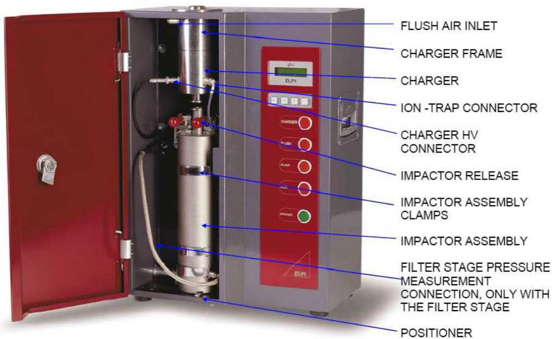
Figura 26 – Schema dei componenti dell’ELPI (Manuale ELPI, Dekati).
