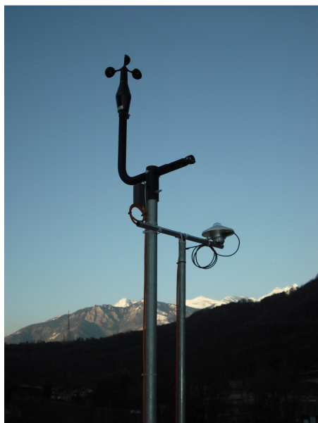
Figura 71 - Sensore del vento e corretto posizionamento del sensore di irradianza solare
