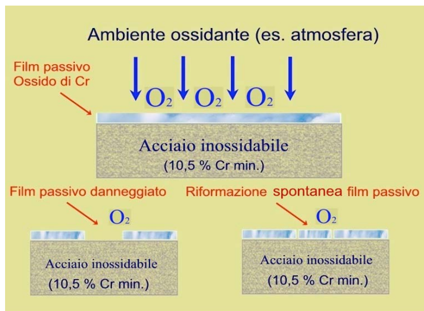
Figura 2.5 - Formazione del film passivo sulla superficie di un acciaio inossidabile
