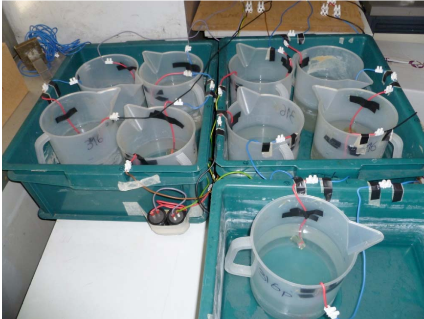
Figura 3.2 – celle di prova con collegamenti elettrici
