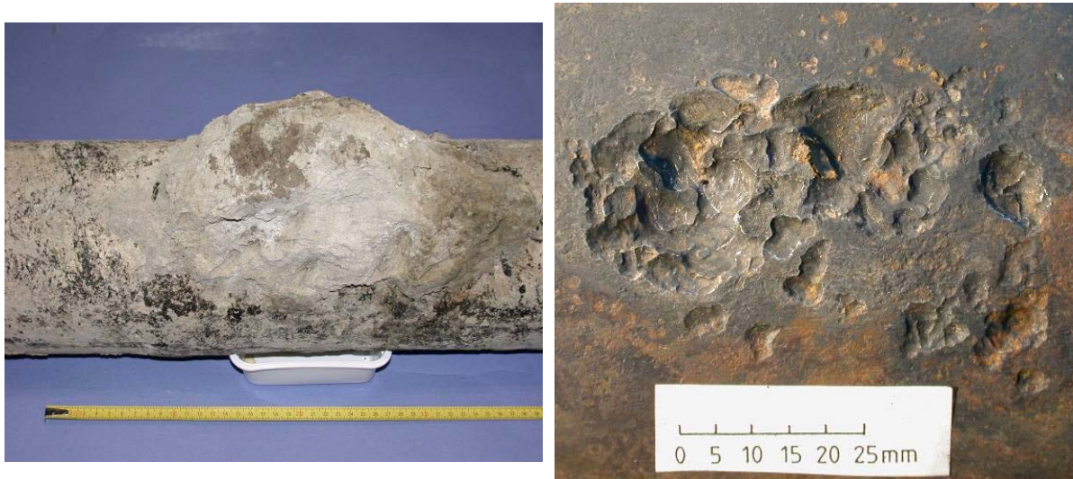
Figura 1.12 – Morfologia di attacco prodotto da corrente alternata su un gasdotto interrato. Prima e dopo la pulizia superficiale
