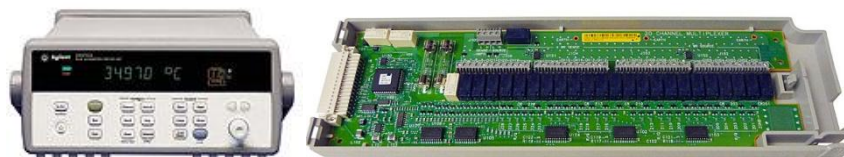
Figura 4.36. Datalogger e scheda di acquisizione utilizzata
