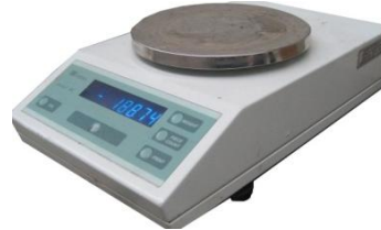
Figura 4.41. Bilancia digitale impiegata nell'impianto
