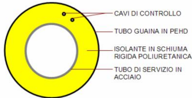
Figura 2.4 – Rappresentazione della sezione trasversale di un tubo per il teleriscaldamento
