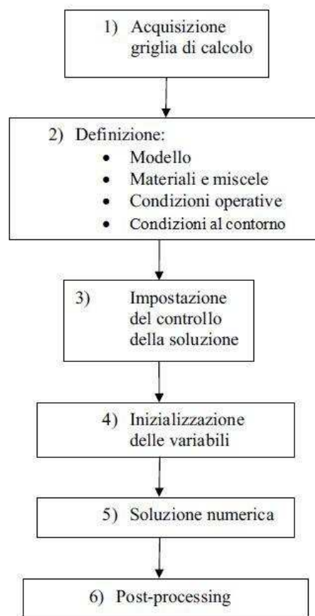
Figura 2.3 Fasi di una simulazione CFD
