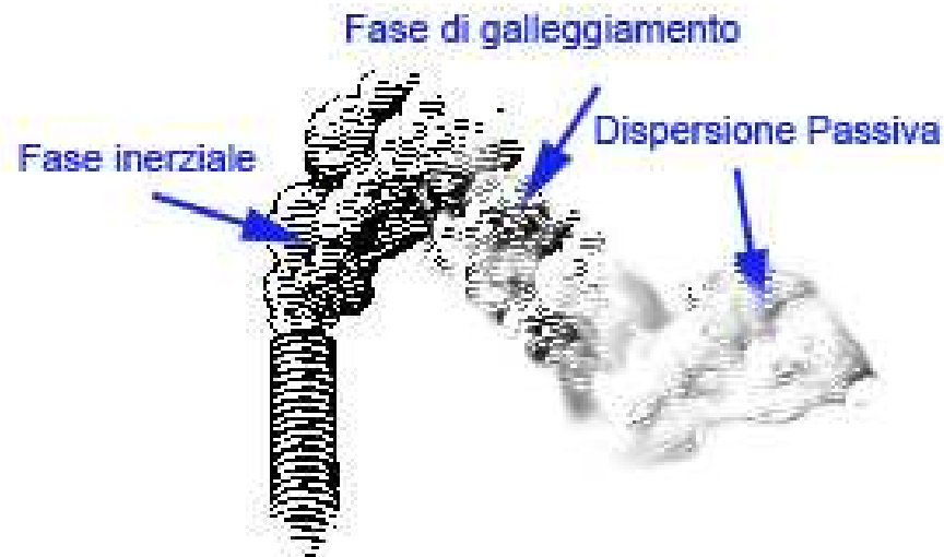
Figura 1.3 Riassunto delle fasi di dispersione di un gas successivamente all'emissione
