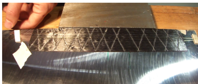
(c) Integrazione del sensore nella resina del primo strato di materiale
