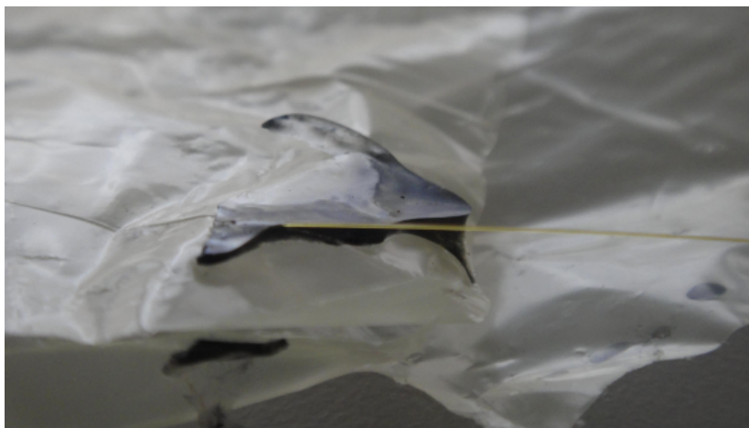
Figura 3.18: Particolare di come la resina contenuta nel materiale composito abbia fatto aderire la fibra ottica ai fogli distaccanti
