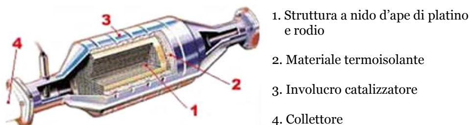
Figura 1. 10: Principio di funzionamento della marmitta catalitica Fonte: http://it.wikipedia.org
