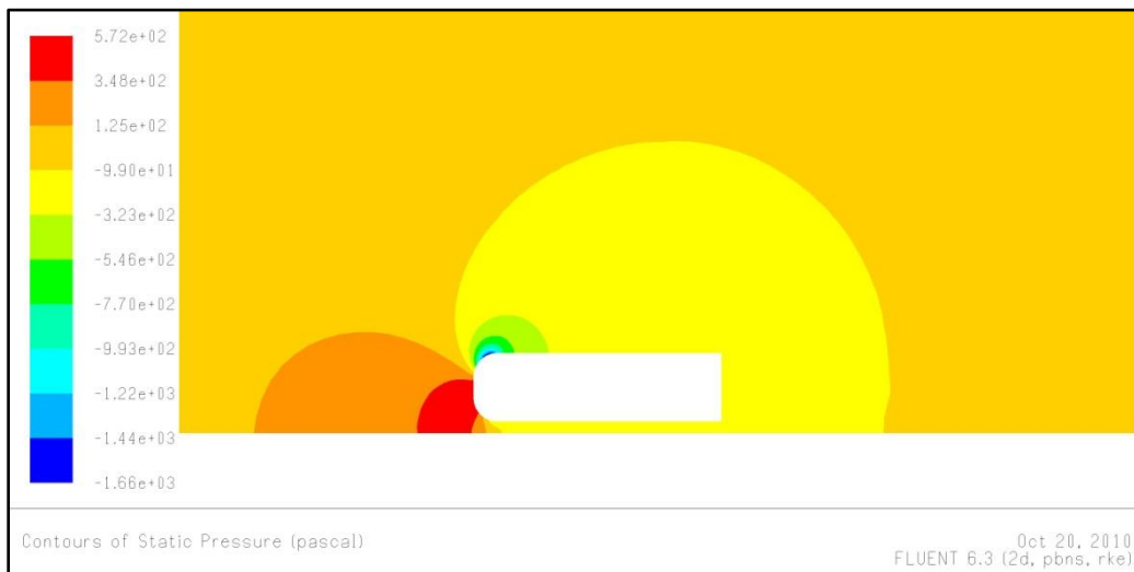
Figura 4.3 Contorno di pressione dell'Ahmed Body con \alpha = 0^\circ
